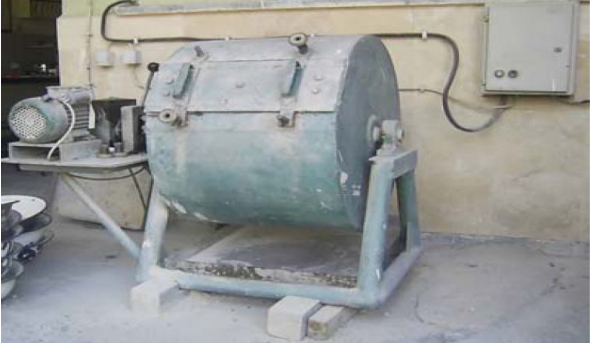
Őekil 3.8. Los Angeles Ařınma Deney Aleti
