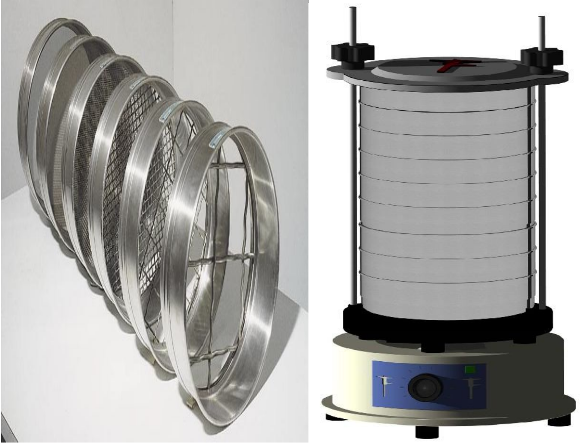
Şekil 3.5. Elek Analizinde Kullanılan Elek Takımı ve Sarsma Makinesi
