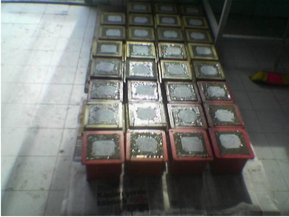
Şekil 3.11. Karışımı Tamamlanmış Taze Betondan 15*15 cm Ebatlarında Küp Numune Olarak Hazırlanması
