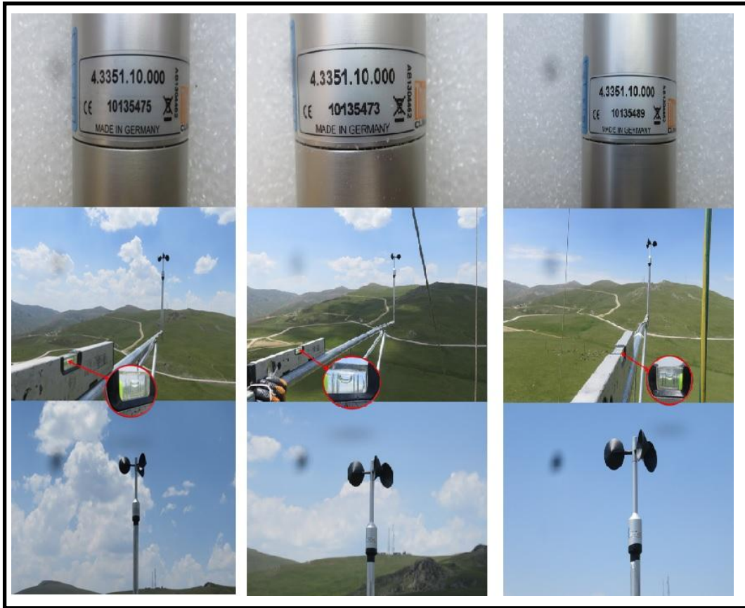
Şekil 3.6. Çalışma sahasında kullanılan 3 Anemometre (65 m– 50 m – 35 m)
