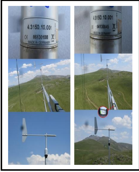
Şekil 3.7. Çalışma sahasında kullanılan rüzgar yön sensörleri ( 72 m – 46 m )
