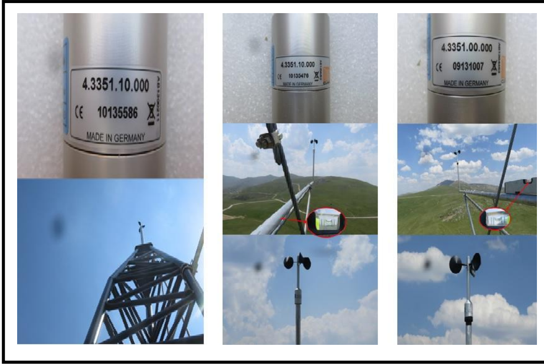
Şekil 3.5. Çalışma sahasında kullanılan 3 Anemometre (80 m – 76 m – 76 m)
