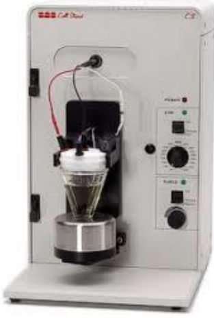
Şekil 3.1: BAS C3 elektrot hücre standı ( www.basinc.com , erişim tarihi 20.08.2018)
