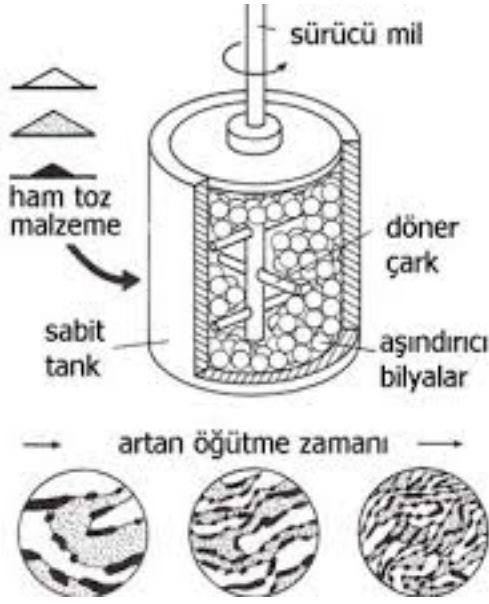
Şekil 3.2. Mekanik Alaşımlama Yöntemi
