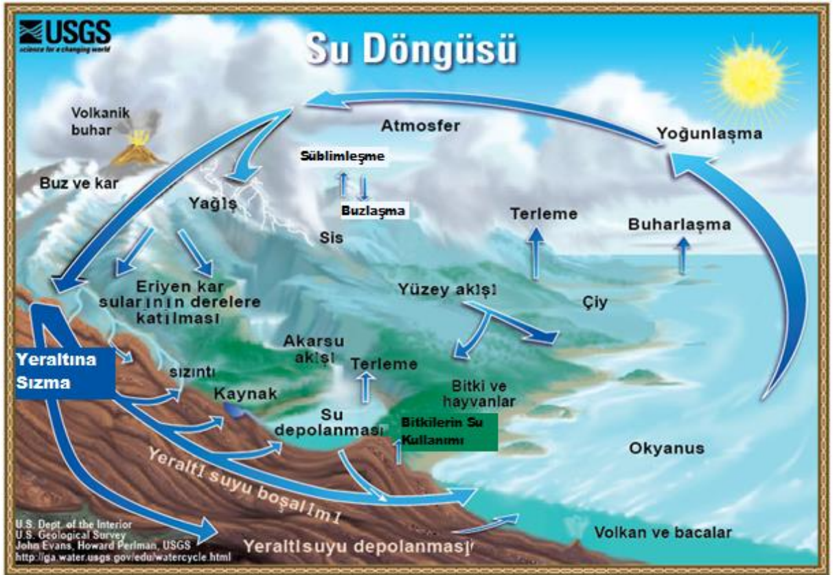
Şekil 2.1. Hidrolojik döngü (su döngüsü) şeması (Anonim 2014c)
