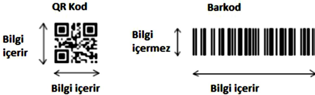
Şekil 5.6: QR kodda verilerin depolanması (Elmalı 2015)
