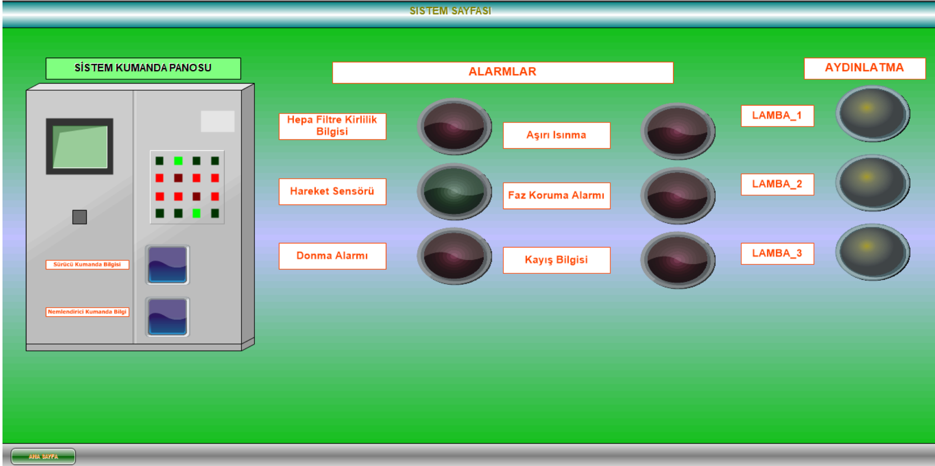
Şekil 5.24: Aydınlatma ve alarm sayfası.
