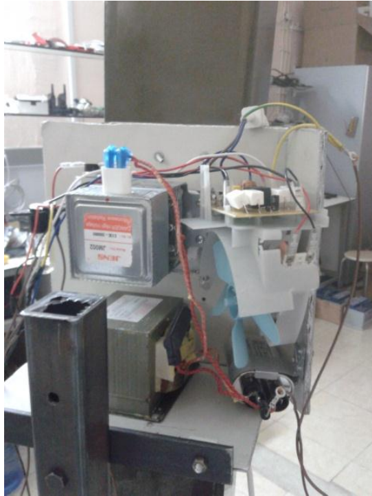
Şekil 3.12. Magnetron elektrik devresi ve elemanları
