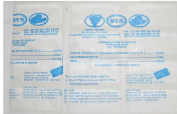
Şekil 3.2. Denemede kullanılan modifiye atmosfer poşeti ve SO 2 generatör pedi
