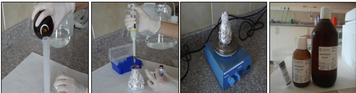
Şekil 3.17. Staining solüsyonun hazırlanması
