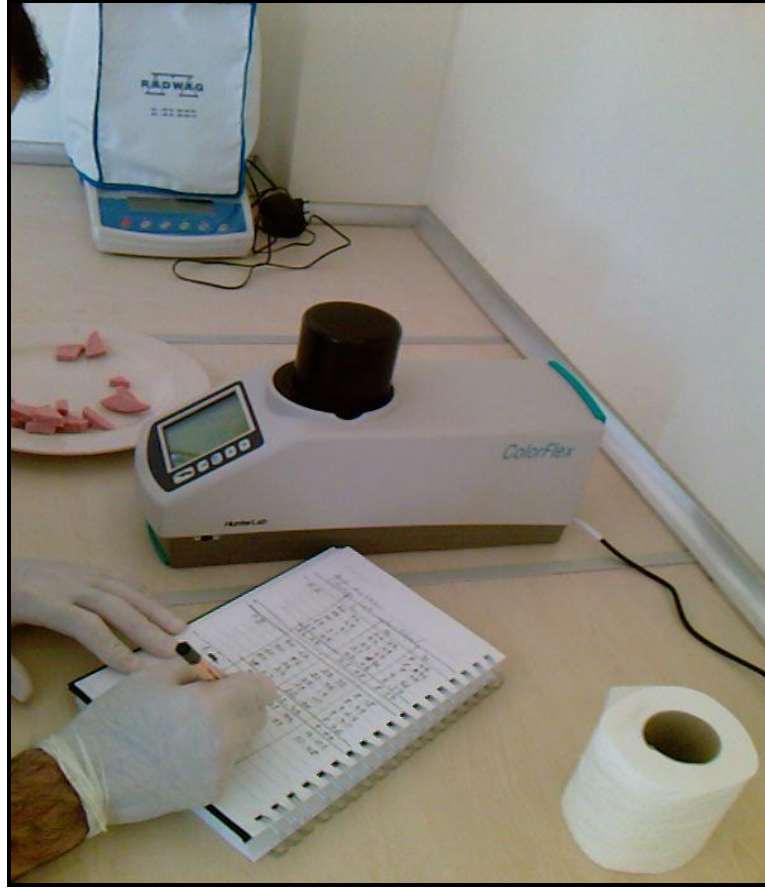
Şekil 3.7. Örneklerin renk ölçümünde kullanılan Colorflex renk ölçüm cihazı
