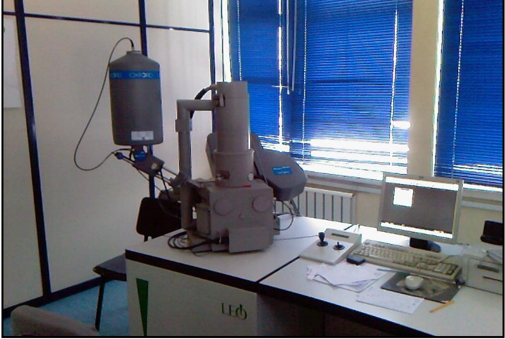
Şekil 3.13. LEO 440 Taramalı Elektron Mikroskobu (SEM)
