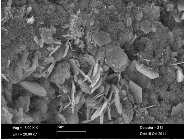
Şekil 4. 38. ZB%6 katkılı hafif beton numunesine ait SEM görüntüsü
