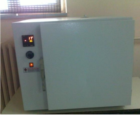
Şekil 3. 8. Birim ağırlık deneyi için kullanılan etüv ve terazi
