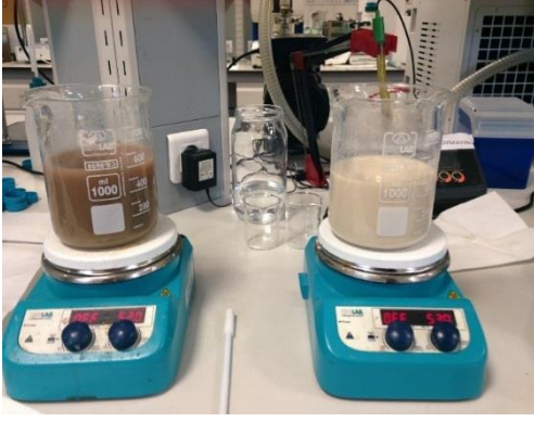
Şekil 3.13. Sağ beherde asidifikasyona uğratılmış çözelti, sol beherde bazifikasyon aşamasındaki çözelti
