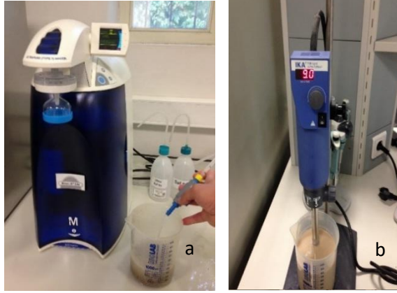
Şekil 3.10. Proteinlerin Dispersiyonu ve Homojenizasyonu a-)Proteinlerin dispers hale getirilmesi, b-)Dispersiyonun homojenize edilmesi
