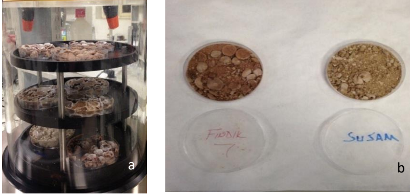
Şekil 3.15. Liyofilizasyon ile Kurutma İşlemi ve Kurutulmuş Numuneler a-) Liyofilize edilen posa örnekleri, b-) Kurutulmuş protein konsantreleri
