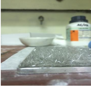
Şekil 3.10. Alüminyum yüzeyin benzoik asit ile kaplanması – kütle transferi katsayısı eldesi amacıyla deneysel çalışma uygulaması
