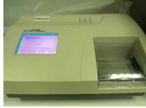
Şekil 3.16. Mikro-plaka metodu ile MİK belirleme çalışmalarına ait görüntüler, Mikro-plaka ve Mikro-plaka okuyucu.
