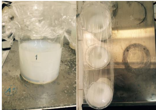
Şekil 3.2. Sol Jel Üretimi sırasında (hidroliz öncesi sol çözeltilerin görünüşü)
