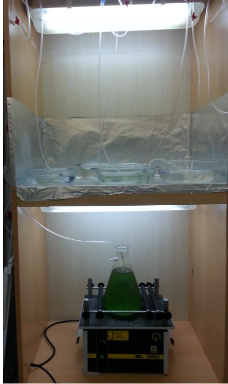
Şekil 3.17. Toksikite seti – Daphnia magna ve alg kültürü yaşam ortamları
