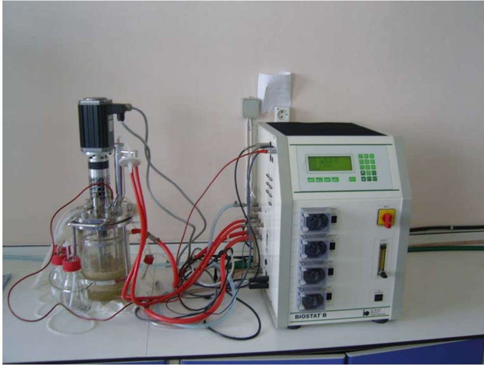
Resim 3.4. Fermentasyonun gerçekleştirildiği fermentör.
