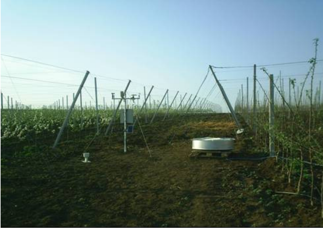
Şekil 3.1. Deneme alanındaki otomatik meteoroloji istasyonu ve A sınıfı kap buharlaşma kabı
