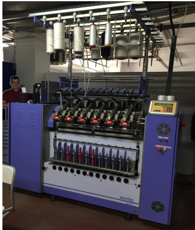
Şekil 6.2. Merlin Numune İplik Eğirme Makinesi
