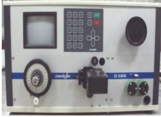
Şekil 6.7. Zweigle G 566 Tüylülük Test Cihazı
