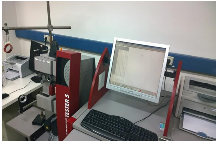
Şekil 6.8. Uster Tester 5 Düzgünsüzlük Test Cihazı
