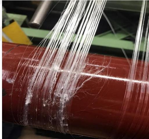
Şekil 2.14. Polipropilen ipliğinde dokuma kaynaklı iplik kopuş hatası
