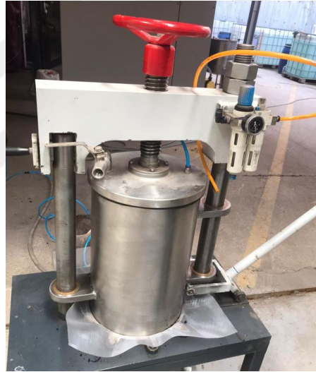
Şekil 2.21. Filtrasyon geçirgenliğinin test edildiği filtre pres makinası
