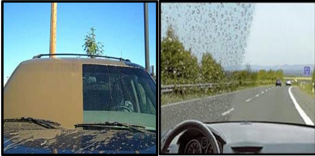
Şekil 5.5. Otomobilde Su Tutmaz, Hidrofob Nanokaplama Örnekleri (Baykara, 2016).
