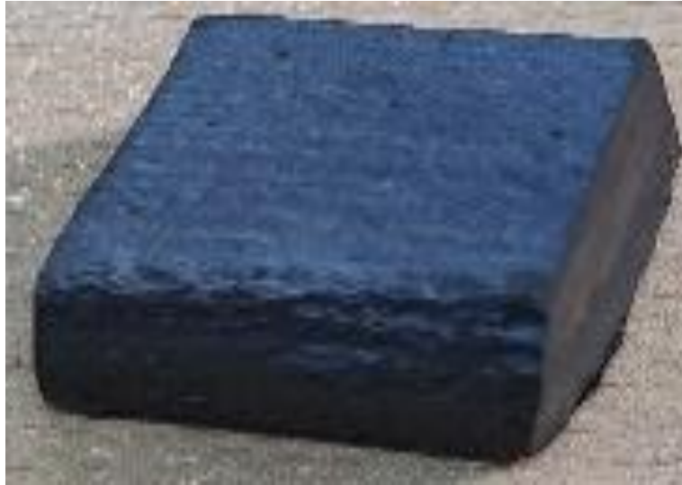
Şekil 6.12. Alaşımsız olan malzemenin ısıl işlem sonrası hava kompresörü ile soğutma işlemine müteakip görüntüsü
