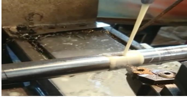
Şekil 6.4. Torna tezgahında parça üzerinde numune boyutlarını belirleme işlemi
