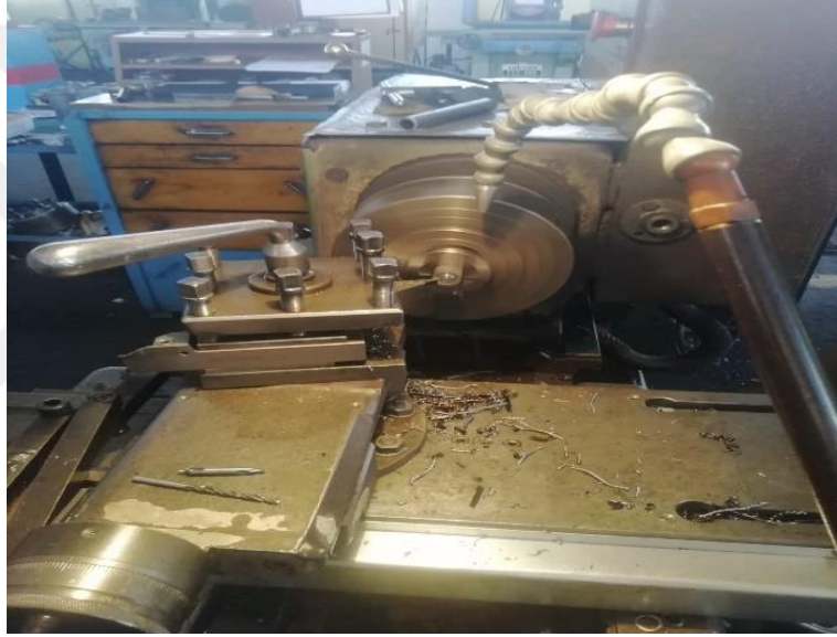
Şekil 6.2. Torna tezgahında kaba yüzey temizleme işlemi
