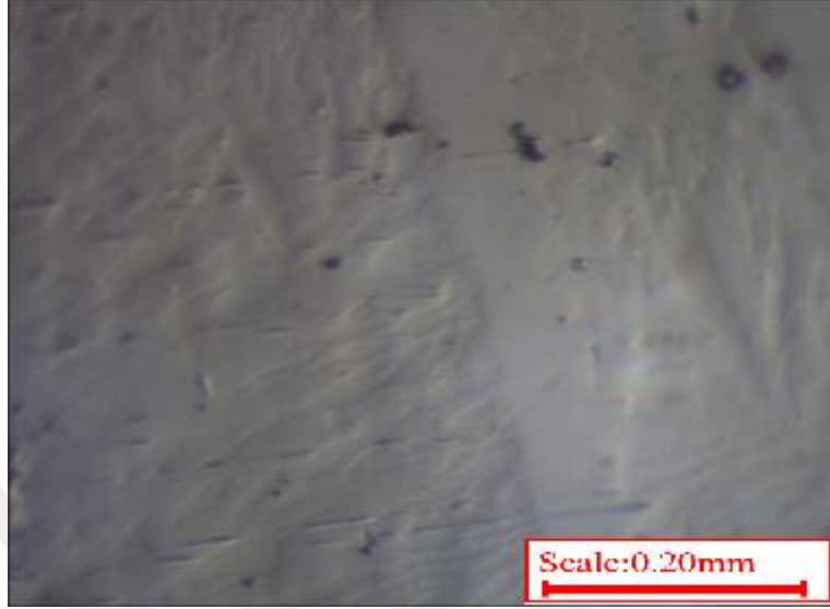
Şekil 7.10. Alaşımsız ve ısıl işlem uygulanmış numune görünümü
