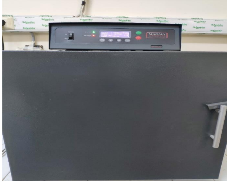
Şekil 6.7. MAGMA THERM marka ısıtma işlem fırını
