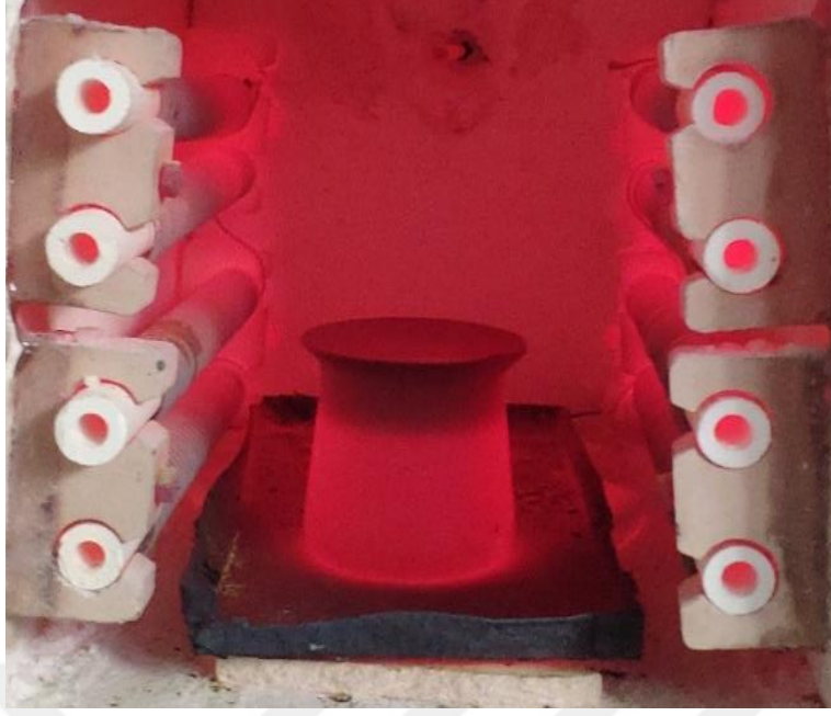
Şekil 6.15. Tuz Banyosu Difüzyon İşlemi Fırın İçi Görünümü
