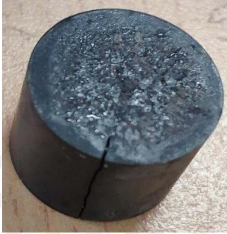
Şekil 6.11. N alaşımlı üründe ısıl işlem sonrası ve su ile soğutmaya müteakip meydana gelen çatlama görüntüsü
