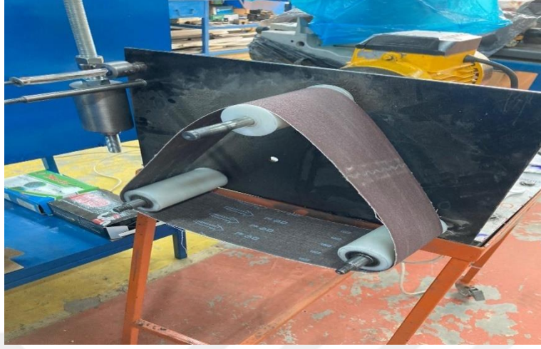
Şekil 6.24. Aşınma test düzeneği ön görünümü
