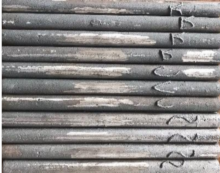
Şekil 6.1. Ötektiküstü Yüksek Kromlu Beyaz Dökme Demirlerde Ce ve B alaşımlı malzemenin işlem uygulanmamış hali
