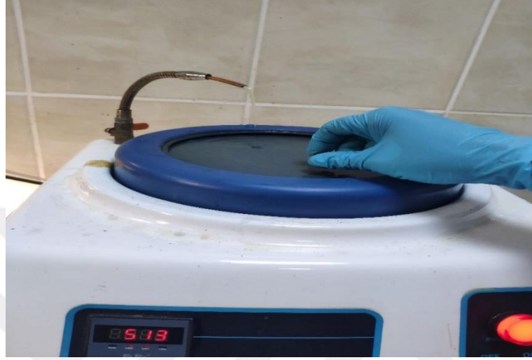
Şekil 6.19. Zımparalama işleminin uygulanması
