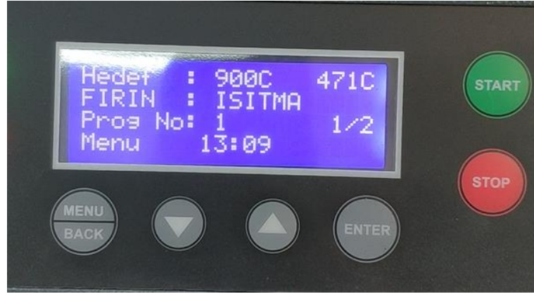
Şekil 6.9. Isıl işlem öncesi fırın sıcaklığının yükselme işlemi
