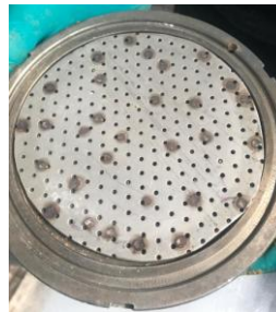
Şekil 3.7 Kurutucuya hava geçişinin sağlandığı delikli perfore sac
