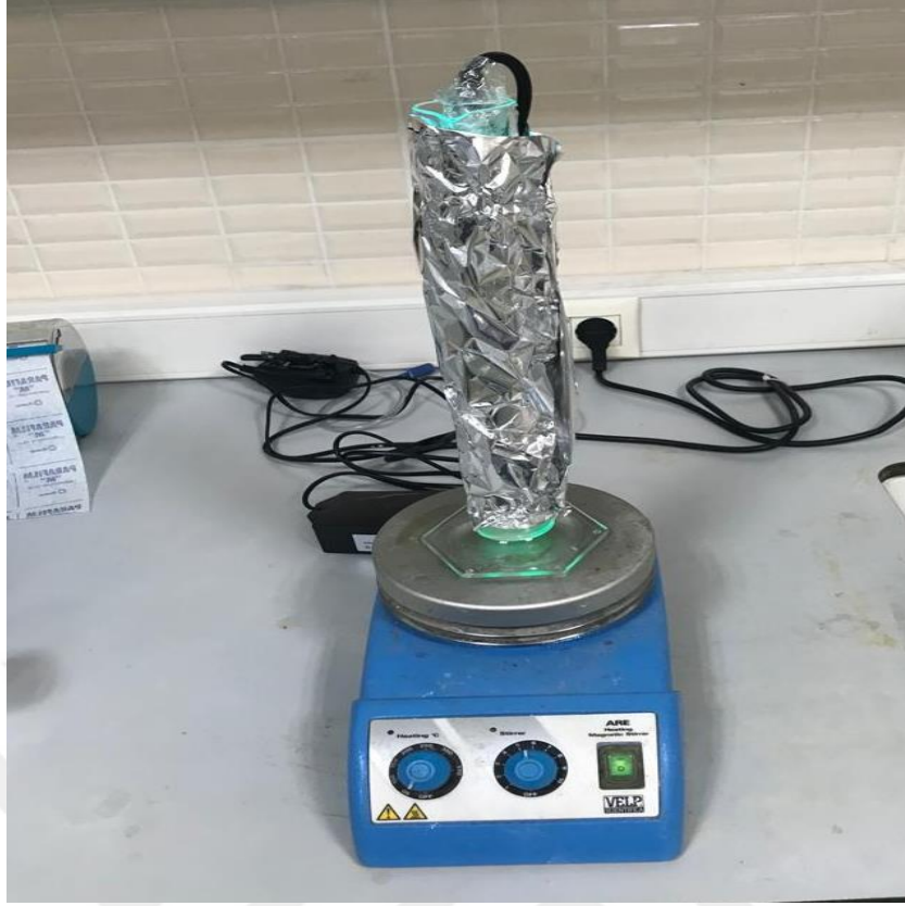
Şekil 2.1. PS/UV-C ve PMS/UV-C deney düzeneği
