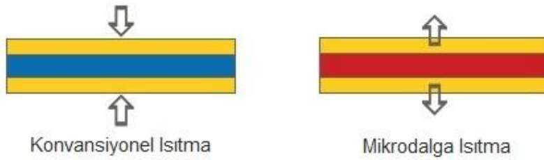
Şekil 1.5. Konveksiyon ile mikrodalga kurutma arasındaki sıcaklık dağılımını gösterimi
