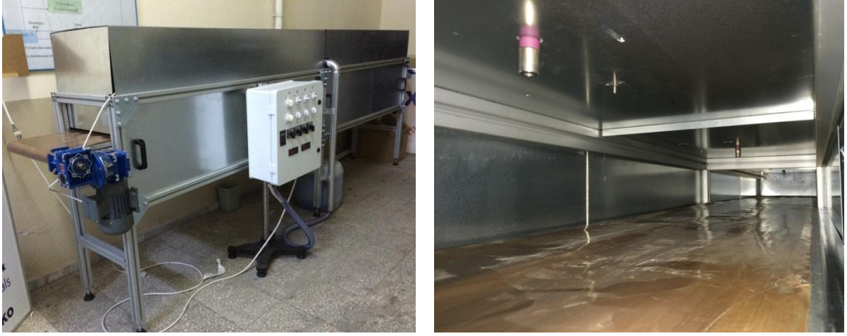
Şekil 3.4. Çalışmalarda kullanılan mikrodalga bantlı kurutucunun dıştan ve içten genel görünümü
