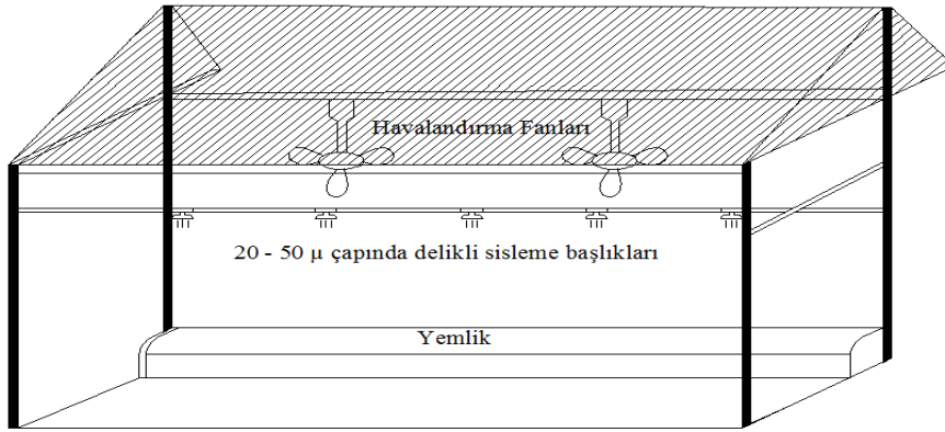
Şekil 2.8. Fan ve sisleme sistemi ile serinletme
