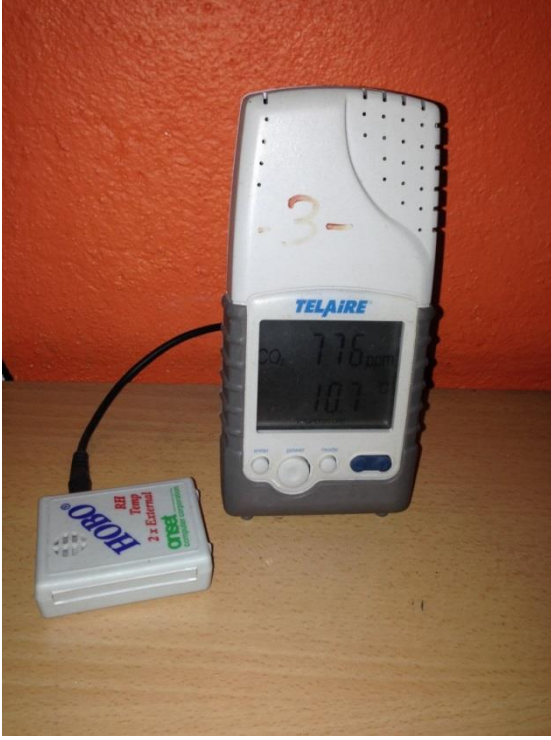
Şekil 3.23. Dolun bölümünde CO 2 ve sıcaklık ölçümü
