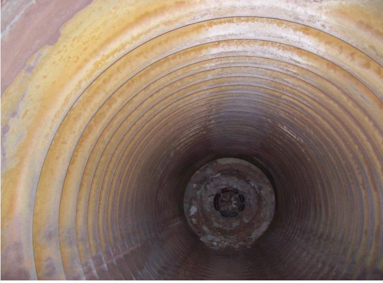
Şekil 3.9. Buhar kazanı cehennemlik ( iç sac )
