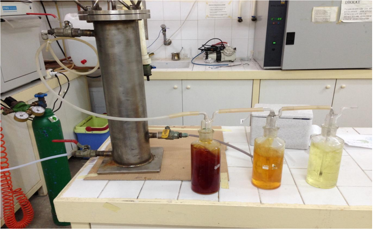
Şekil 3.6. Ozon çıkışının KI çözeltisi içinde tutulması 2
