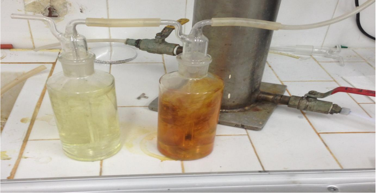
Şekil 3.5. Ozon çıkışının KI çözeltisi içinde tutulması
