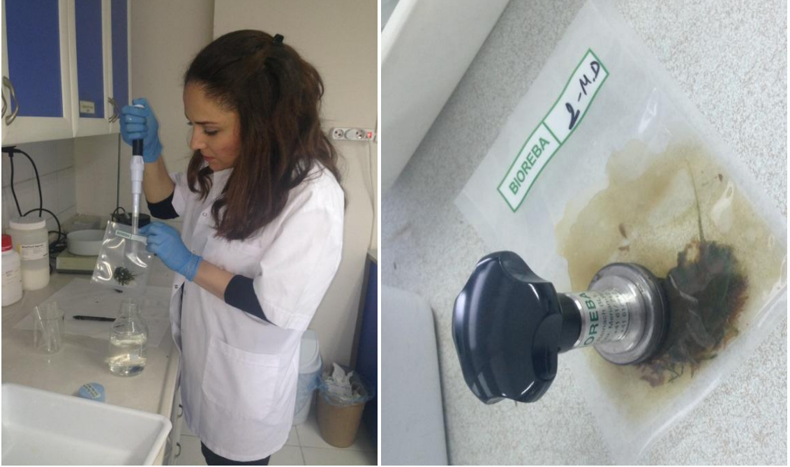
Şekil 3.2. Enfekteli havuç bitki materyallerinin steril ezme poşetleri içerisinde el homojenizatörü ile ezilerek bitki özularının elde edilmesi
