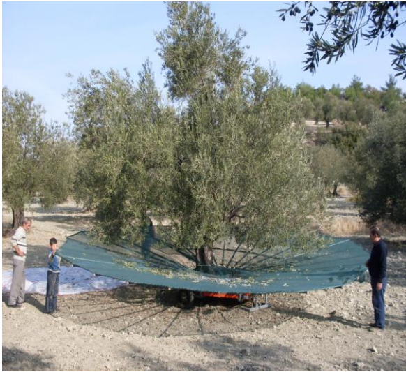
Şekil 4.10 Platform & dal çırpıcı makine ile yağlık zeytin hasat denemeleri
