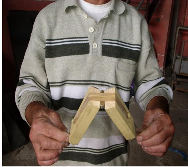
Şekil 3.7 Gerdirmeyi sağlayan ve otomatik açılan lastikli menteşe sistemi
