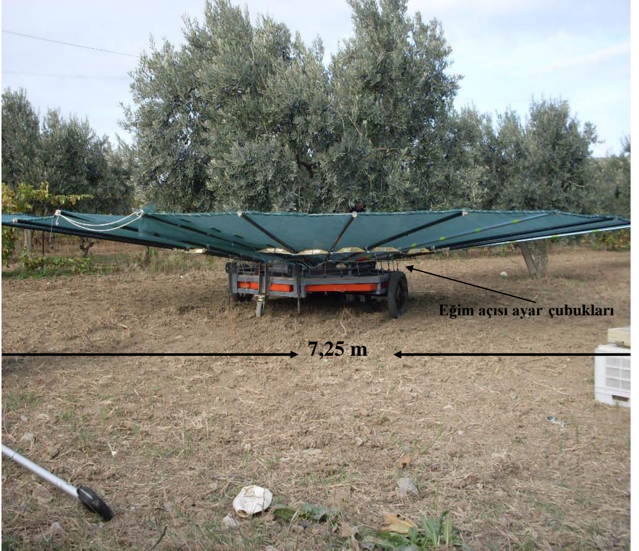
Şekil 3.6. Toplama platformu açılmış hali
