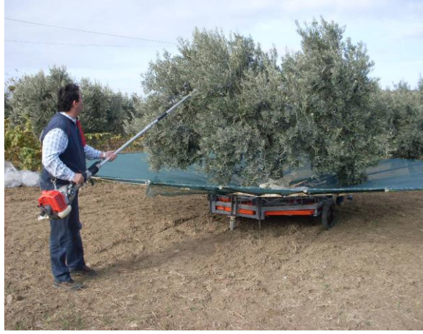
Şekil 3.16. Dal sarsıcı ve platformla zeytin hasadı
