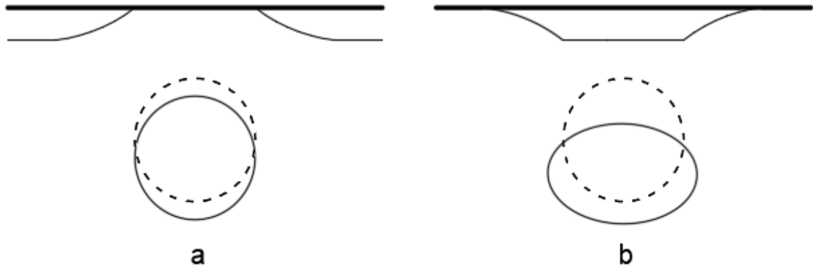
Şekil 2.3. Boruların yük altındaki davranışı a) rijit boru b) esnek boru
