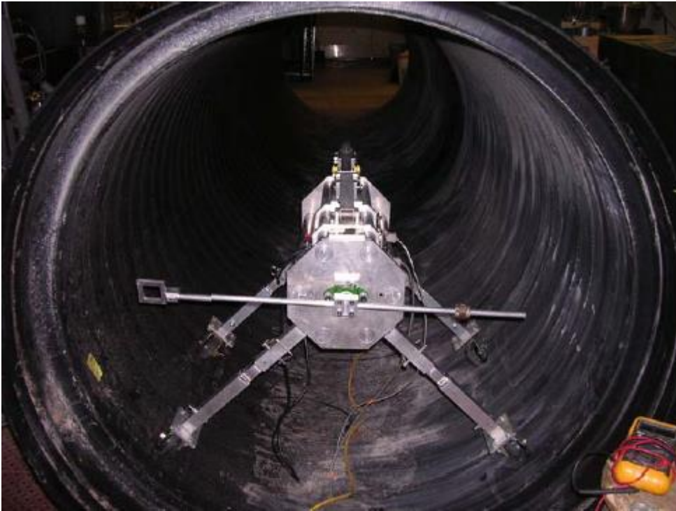
Şekil 3.25. Boru içerisindeki lazer profilometrenin görünümü (Sargand ve Masada, 2007)
