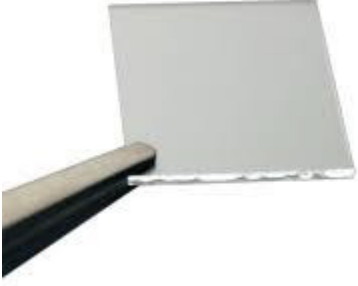
Şekil 2.9. ITO (İndiyum katkılı kalay oksit) kaplı cam
