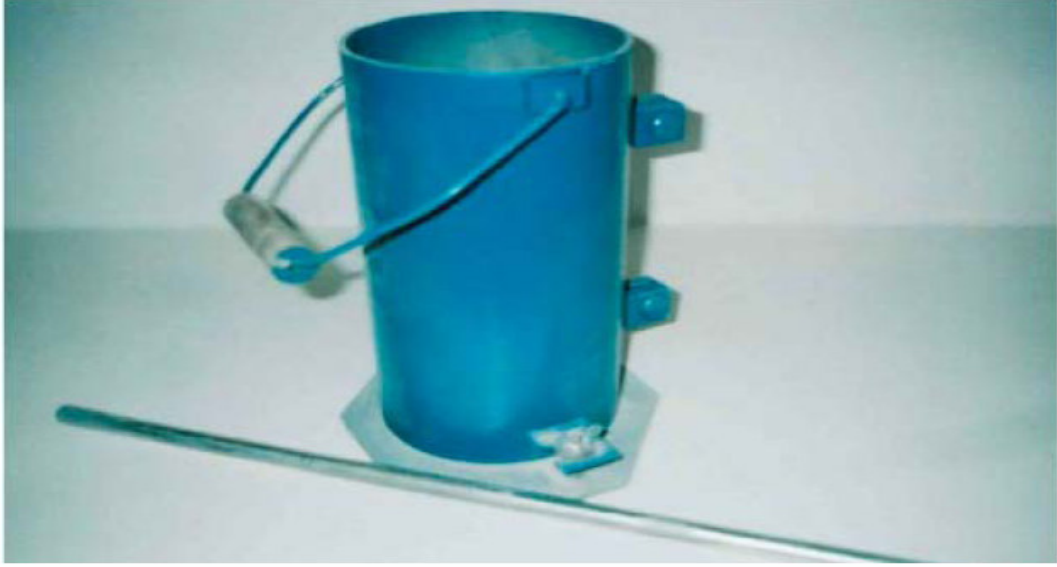
Şekil 4.4. Agregada gevşek ve sıkışık birim hacim ağırlık aleti
