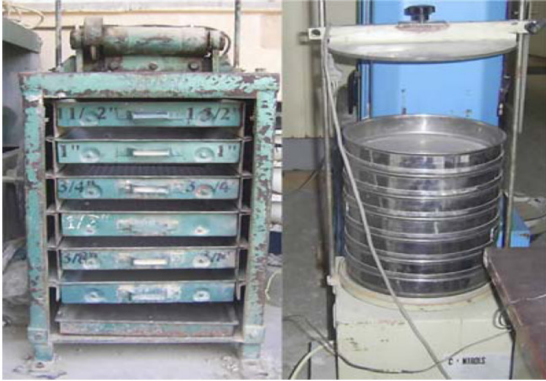
Şekil 4.3. Elek analizinde kullanılan elek takımı ve elek sarsma makinesi
