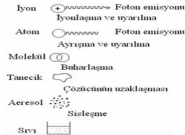
Şekil 2.10. Plazmada gerçekleşen atomlaşma ve uyarılmanın şematik gösterimi (Daşdemir 2008, Atakuru 2009).
