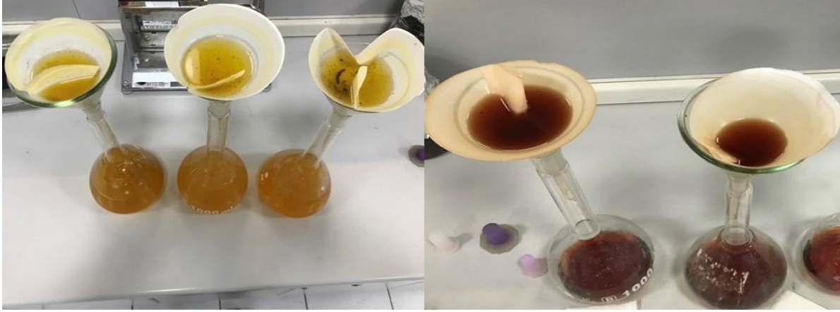
Şekil 4.4. İzopropil Alkol-Muz Kabuğu ve İzopropil Alkol-Meyan Kökü Çözeltilerinin Filtre Kağıdı Aracılığıyla Süzülmesi
