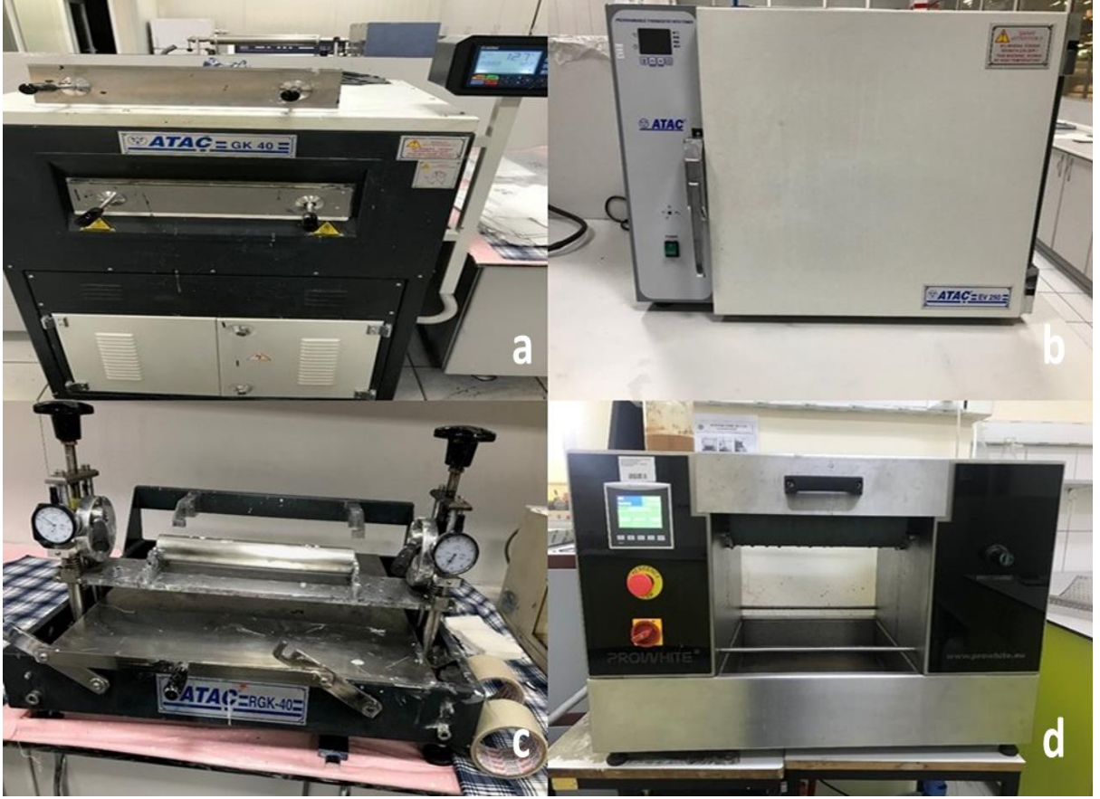
Şekil 4.1. Ekstraksiyon ve Güç Tutuşurluk Terbiyesi İçin Kullanılan Ekipmanlar: a) Laboratuvar Tipi Ramöz, b) Etüv, c) Laboratuvar Tipi Kaplama Cihazı, d) Yatay Tip Pnömatik Sıkma Makinesi
