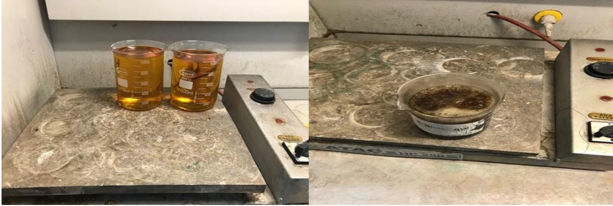
Şekil 4.5. İzopropil Alkolün Çözeltiden Uzaklaştırılma Adımı
