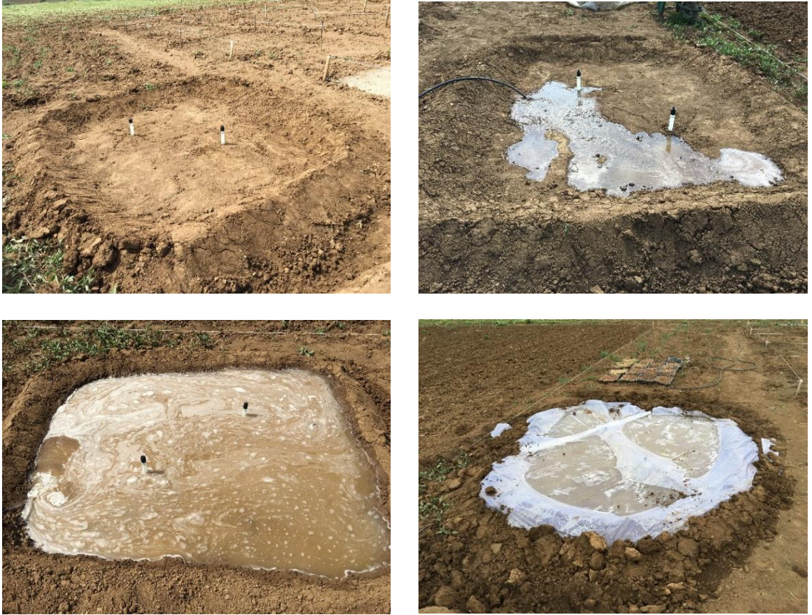
Şekil 3.6. Toprak nem takip aracı hazırlanan kalibrasyon havuzu
