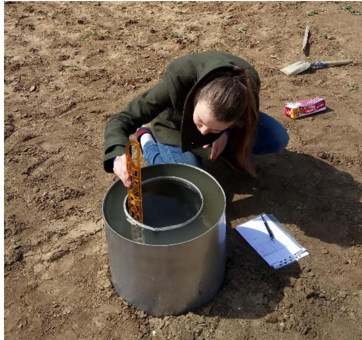
Şekil 3.10. Çift silindirli infiltrometre testi
