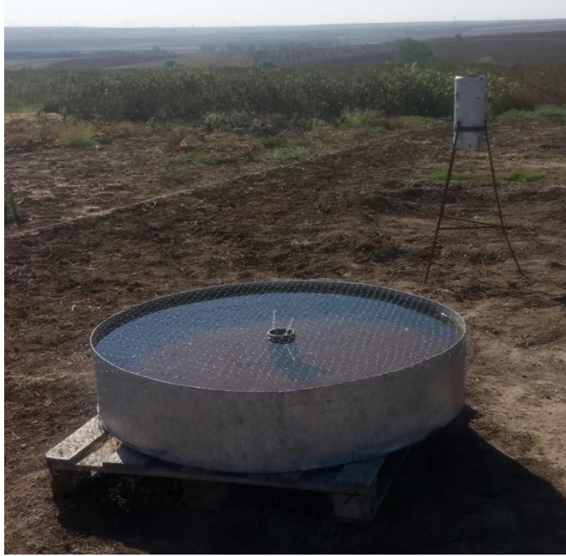
Şekil 3.8. Alandaki A sınıfı buharlaşma kabı
