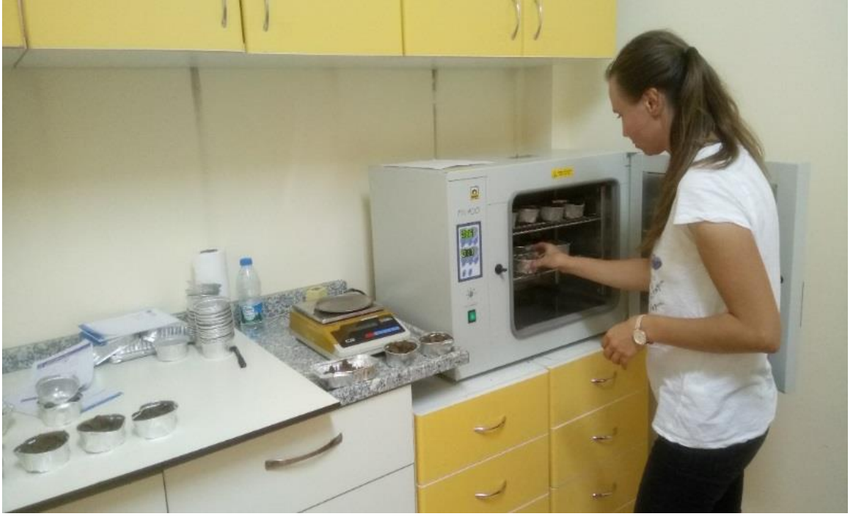
Şekil 3.15. Gravimetrik yöntem ile toprak nem tayini
