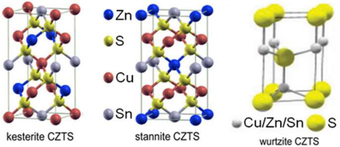
Şekil 2.7: CZTS nin kristal yapısı (Wang ve ark 2014)
