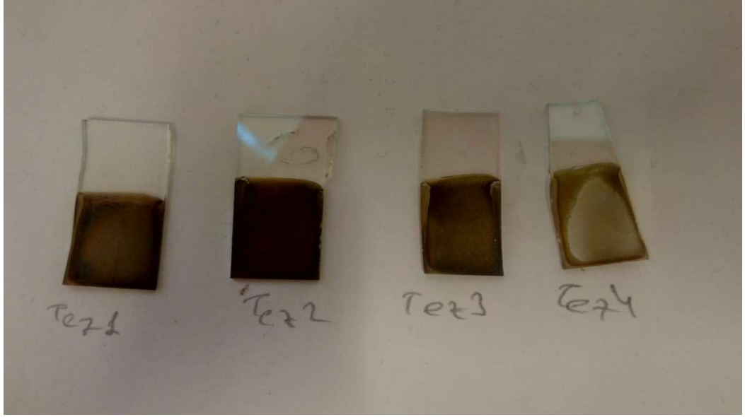
Şekil 4.2: (Tez1) -1,6V sabit voltajda kaplanan CZTS ince film (Tez2) Darbeli elektrokimyasal kaplama ile 30 dk da kaplanan film (Tez3) Tez1 de kaplanan filmin tavlandıktan sonraki görüntüsü (Tez4) Tez2 de kaplanan filmin tavlandıktan sonraki görüntüsü
