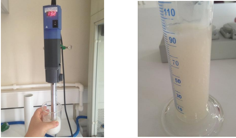
Şekil 3.9. Köpük oluşturma kapasite ve stabilitelerinin belirlenmesi
