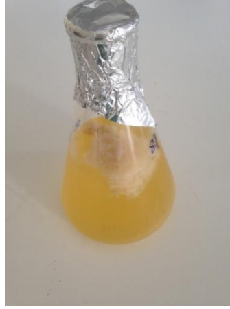
Şekil 3.6. Santrifügasyon sonrası izopropanol ile ksantan gamın eldesi
