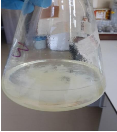
Şekil 3.6. Santrifügasyon sonrası izopropanol ile ksantan gamın eldesi
