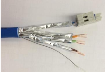
Şekil 3.9. CAT 6A U/FTP data kablosu konnektör takılı hali (Reçber Kablo’nun izni ile kullanılmıştır)
