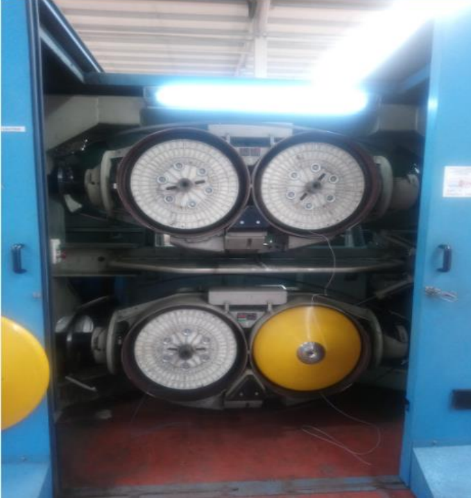
Şekil 4.34. İkili büküm (Double Twist) DBH-4 makinesi (Reçber Kablo'nun izni ile kullanılmıştır)
