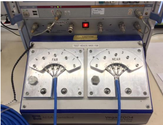
Şekil 3.10. Kablonun alt ve üst uçlarının Network Analyzer test cihazına bağlantısı (Reçber Kablo’nun izni ile kullanılmıştır)
