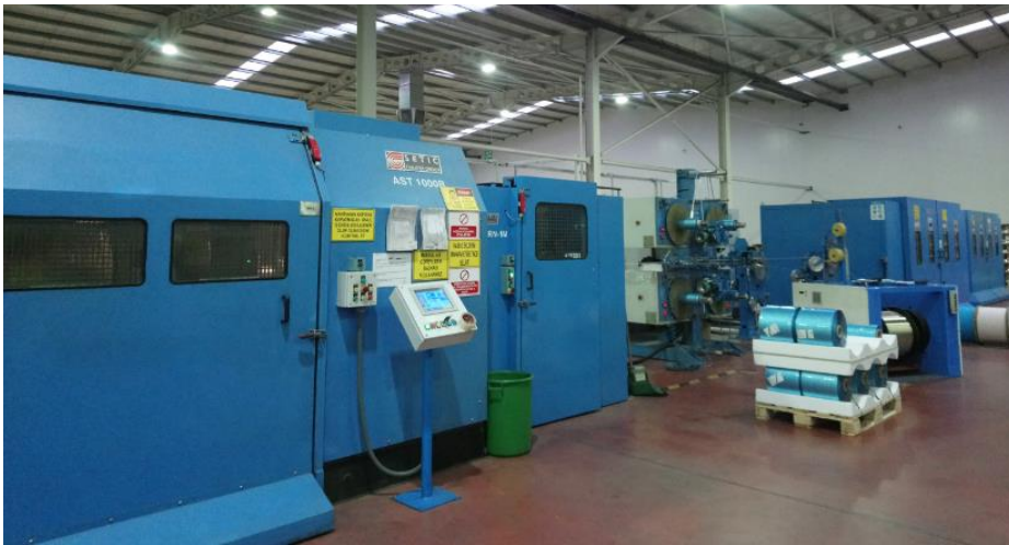
Şekil 3.20. Data büküm makinesi-5/DBH-5 (Reçber Kablo’nun izni ile kullanılmıştır)
