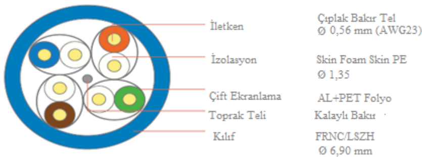
Şekil 3.5. Cat 6A U/FTP dairesel kesit (Reçber Kablo'nun izni ile kullanılmıştır)
