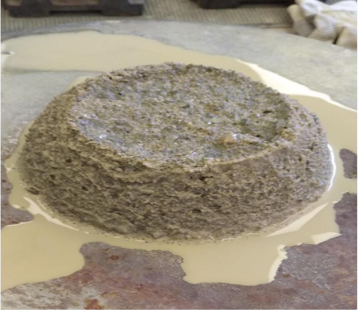
Şekil 52: Numunenin yayılması ve kanama
