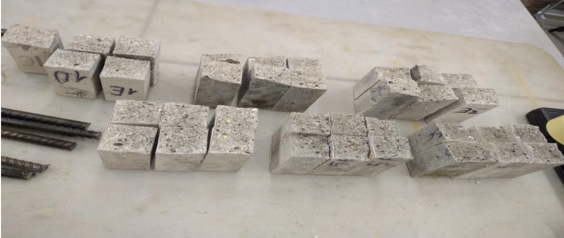
Şekil 45: Eğilme basınç ile kırılan örnekler
