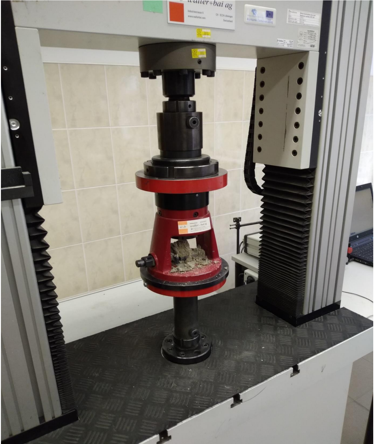
Şekil 46: VGTU’da bulunan basınç ve eğilme testinin yapıldığı makine
