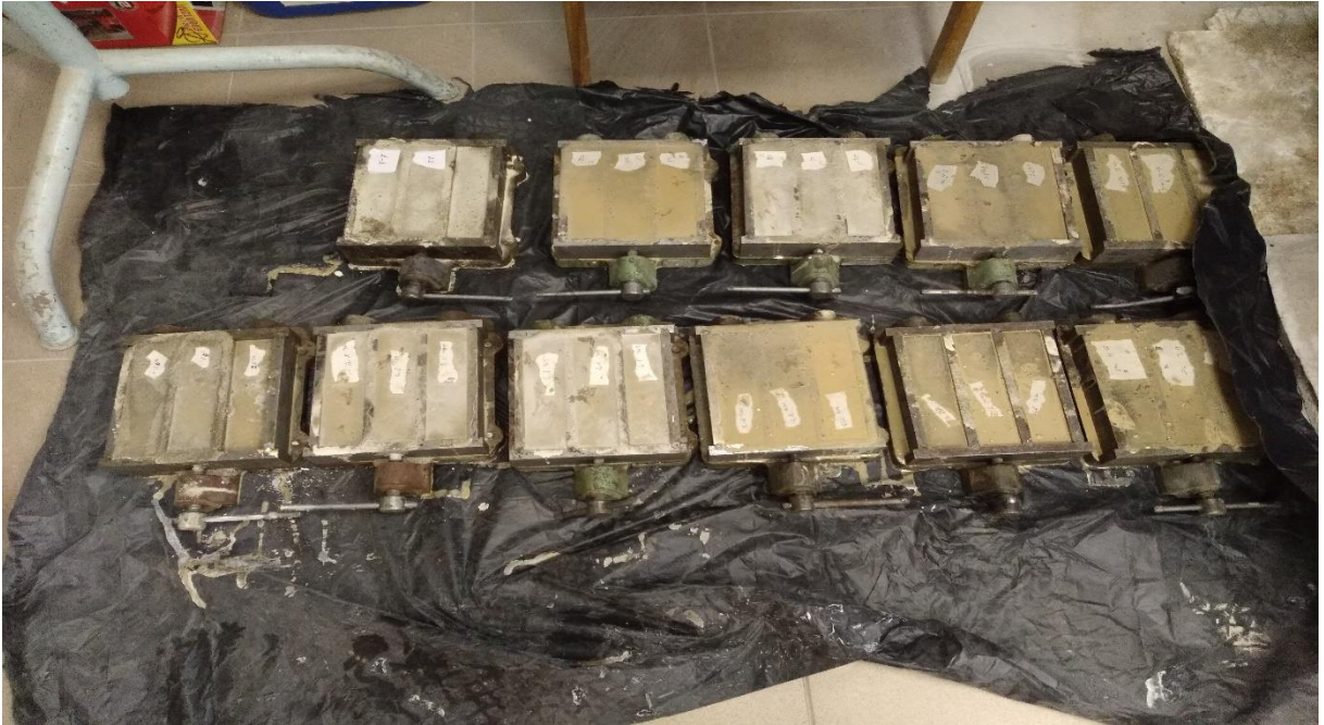
Şekil 42: Sıkıştırma sonrası kalıplar ve polietilen torba
