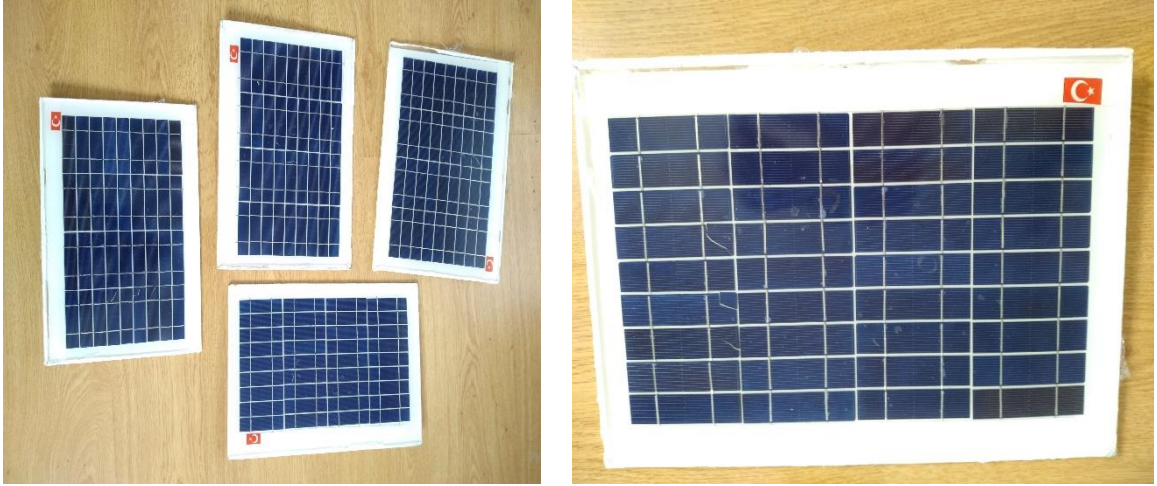
Şekil 36: Hücresel zarara uğramış Polikristal silikon güneş panelleri
