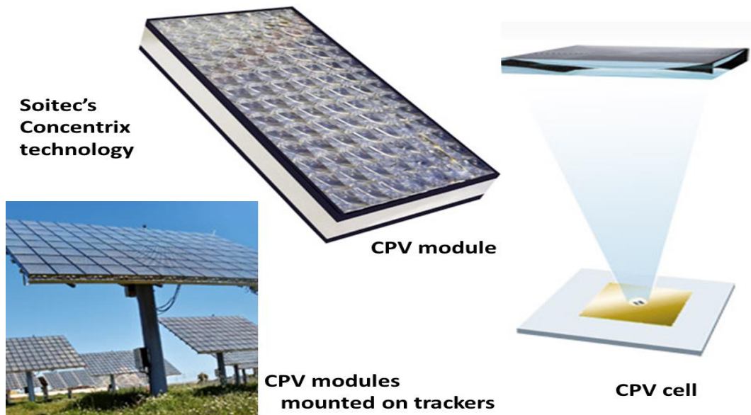
Şekil 21: CPV güneş hücresi ve panelleri
