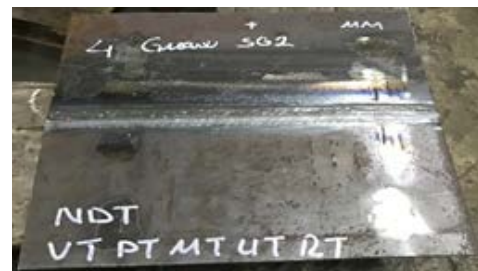
Şekil 2. Uygun kaynak parametreleri ile kaynak uygulaması tamamlanmış numune
