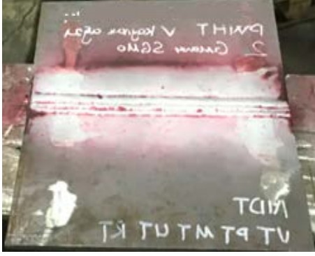
Şekil 3. Vt, Mt, Pt, Ut uygulanmış numune.
