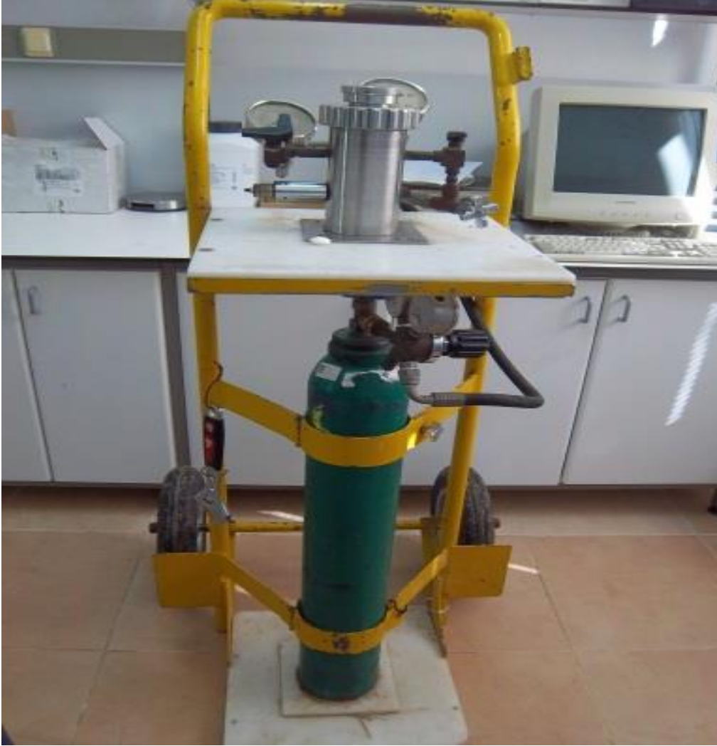
Şekil 3.4. Yaprak su potansiyeli ( \Psi ) ölçme cihazı olan Scholander basınç odasından bir görünüm
