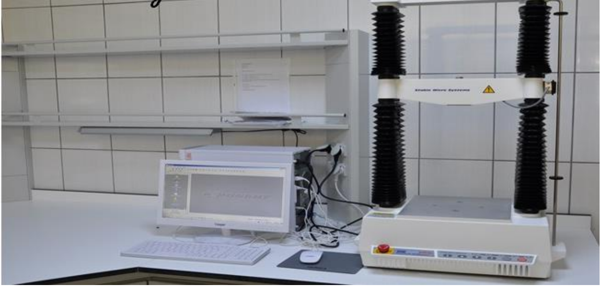
Şekil 3.14. T.A. HDPlus tekstür analiz cihazı
