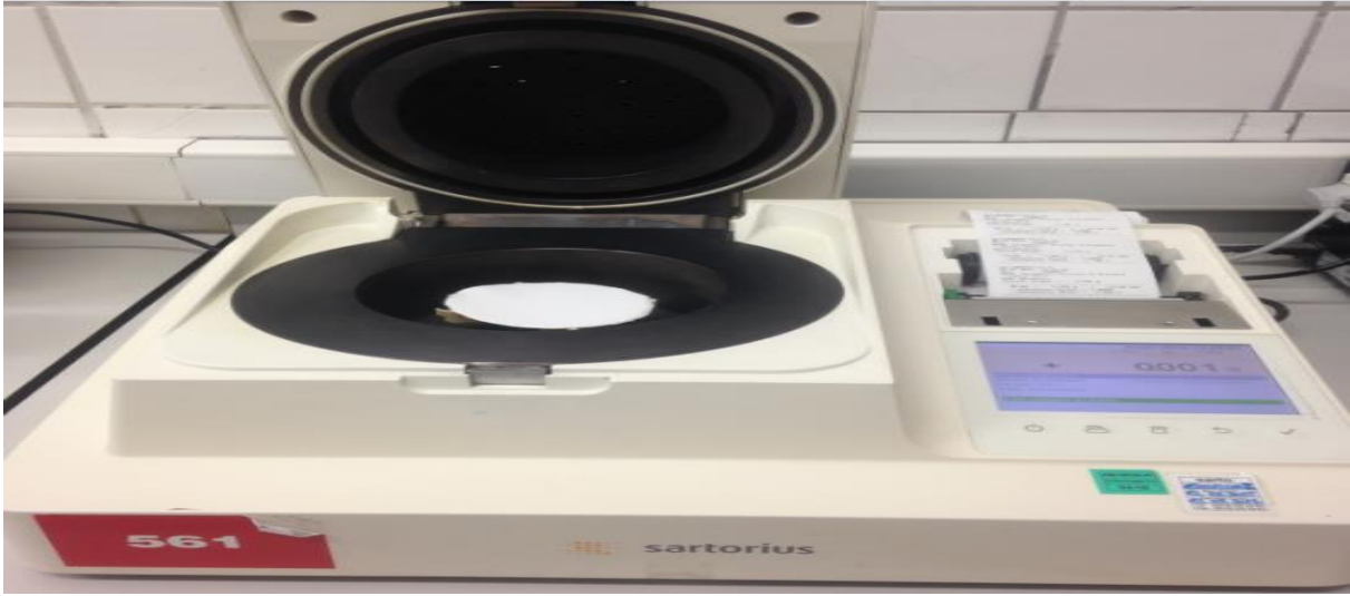
Şekil 3.11. Sartorius (LMA200PM) marka Toplam Kuru Madde analiz cihazı
