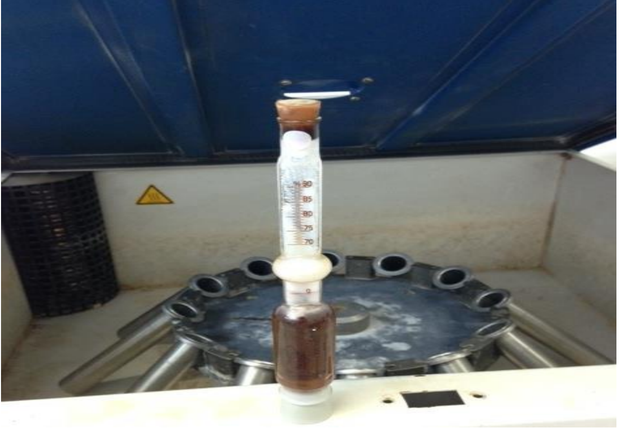
Şekil 3.12. Gerber yöntemi yağ tayininde kullanılan santrifüj ve Gerber bütirometresi
