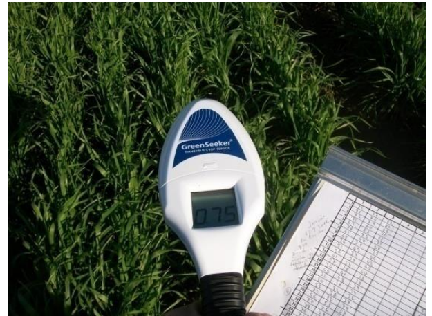
Şekil 3.31. Vejetasyon indeksi ölçümlerinde kullanılan optik el sensörü (NDVI)
