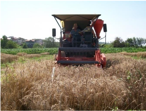
Şekil 3.28. Tarla Denemesinde parsel biçerdöveri ile hasat
