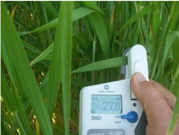
Şekil 3.30. Bayrak yaprağı klorofil içeriği ölçümlerinde kullanılan klorofilmetre
