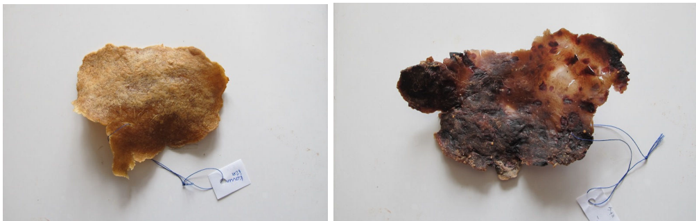
Şekil 60. Kavun özü ve incir kabuğu kullanılarak yapılan patates nişastalı biyoplastik (Deney 17-72, 17-73)
