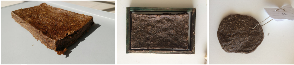
Şekil 80. Kanola peletli ve balmumlu biyoplastik kuruduktan sonra boyut kaybı, Boyut: 15x22x0,8 cm (Deney 17-11)
