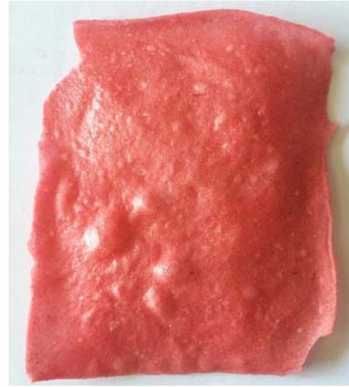
Şekil 57. Agar agar ve %20 tapioka nişastası, % 80 mısır nişastası kullanılarak yapılan biyoplastik, EVA üzeri katı sürüm (Deney 17-45)
