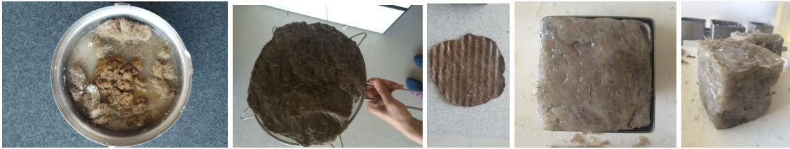
Şekil 77. Deniz erişteli ve kanola peletli biyoplastik ile saf deniz erişteli biyoplastik, Boyut: 6x6x6 cm (Deney 17-21,17-18)
