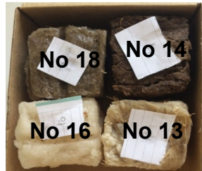
Şekil 89. 6x6x6 cm'lik basınç deneyi yapılan numuneler
