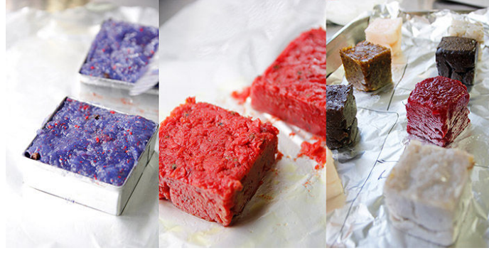
Şekil 40. Gıda boyası kullanılarak yapılmış biyoplastik, Boyut: 5x5x5 ve 5x5x1 cm (Fotoğraf: Julia Janku)
