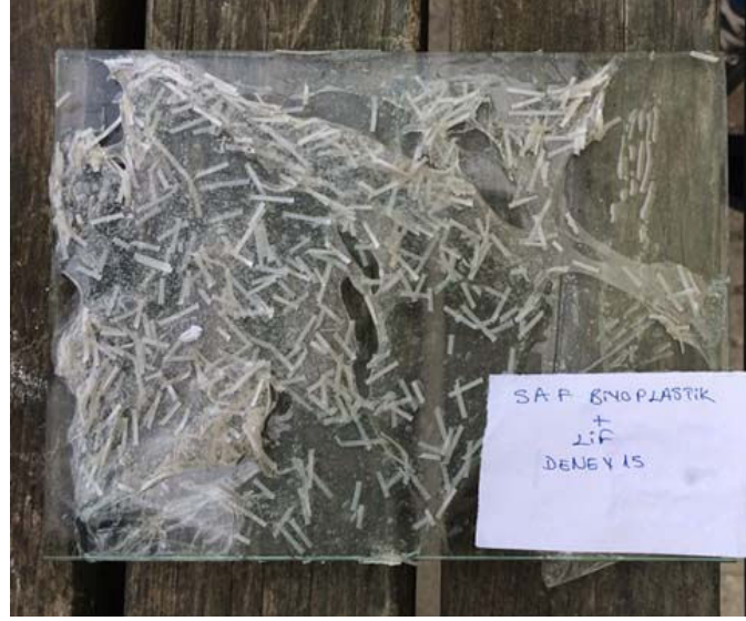
Şekil 67. Kopolimer lifli saf biyoplastik, Cam yüzey üzerine sürüm, Boyut: 15x20cm (Deney 16-15)
