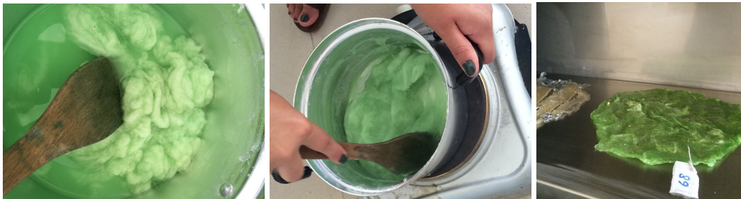
Şekil 52. Pamuk ve yeşil gıda boyası kullanılarak yapılan biyoplastik (Deney 16-68)
