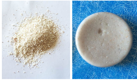
Şekil 63. Yumurta kabuğu unu kullanılarak yapılan ve agar agarlı, %67 tapiyoka nişastası, %33 buğday nişastalı biyoplastik (Deney 17-53)
