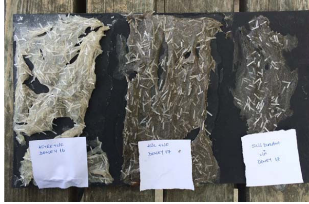
Şekil 69. Kitreli, meşe küllü ve silis dumanlı kopolimerli biyoplastik, Doğal kauçuk yüzey üzerine sürüm, (Deney 16-16, 16-17, 16-18).
