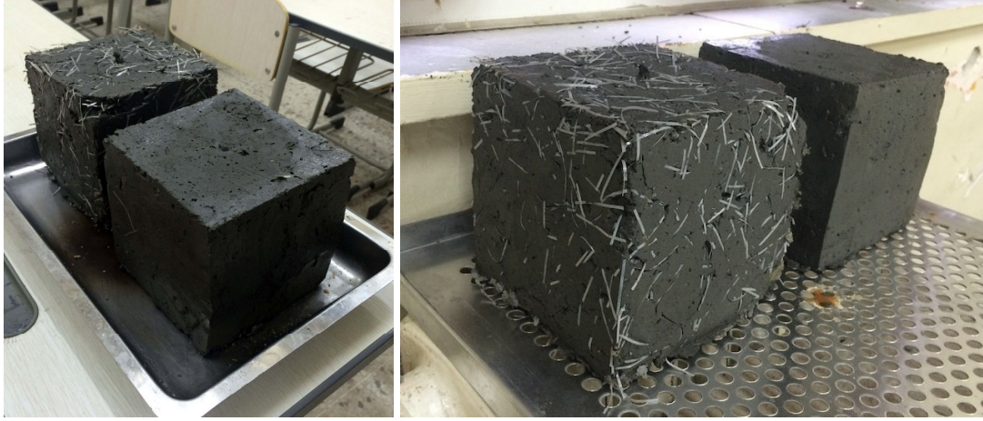
Şekil 49. % 50 Biyoplastik, % 50 Karışım: (Agrega 59%, 40% silis dumani, 1% kopolimer lifi), Boyut: 15 x 15 x 15 cm (Deney 16-6)
