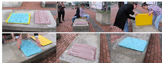
Şekil 72. Bağlayıcı olarak gazlı bez kullanılan mısır nişastalı biyoplastikten zemin kaplaması denemesi
