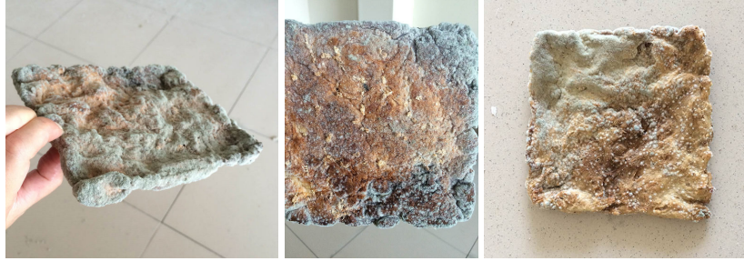
Şekil 94. Bir yıl sonra bozulmaya ve küflenmeye başlayan biyoplastikler, Boyut: 15x15x0,3cm
