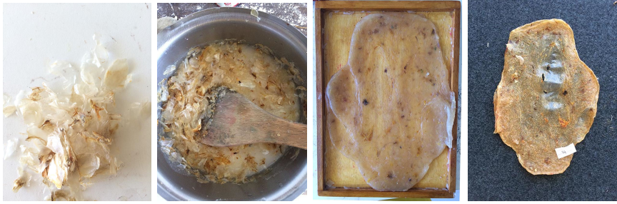
Şekil 59. Kabak çekirdeği zarı ilaveli ve agar agarlı patates nişastalı biyoplastik (Deney 17-34)
