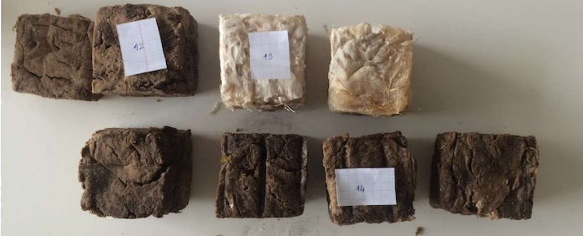
Şekil 81. Kanola peletli biyoplastik, Agar agar ve kanola peletli biyoplastik ile balmumlu kanola peletli biyoplastik, Boyut: 6x6x6cm (Deney 17-12, 17-13, 17-14)
