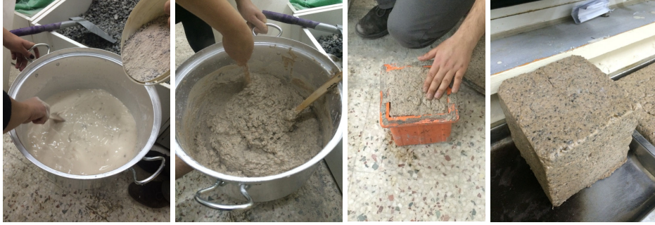
Şekil 47. % 50 Biyoplastik, % 50 Karışım: (Agrega:0-4 mm), Çelik kalıp, Boyut: 15 x 15 x 15 cm (Deney 16-3)
