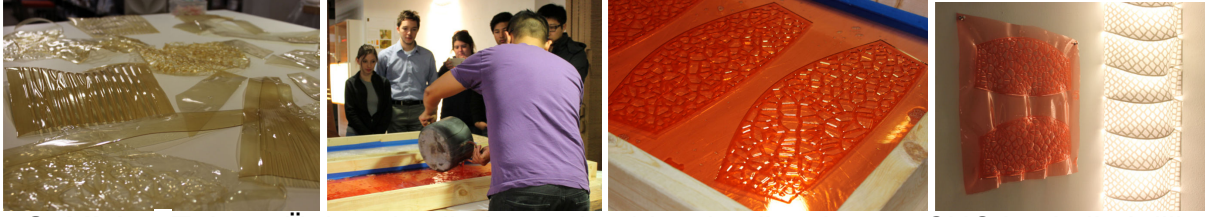
Şekil 18. Teksas Üniversitesi'nde yapılan biyoplastik çalışmayı, CNC kesimli akrilik kalıplarda üretilen biyoplastikler (Url-9).
