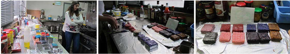
Şekil 39. Gıda boyası kullanılarak yapılmış biyoplastik, Boyut: 5x5x5 ve 5x5x1 cm
