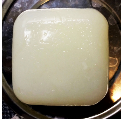
Şekil 12. Saf biyoplastik ince levha halinde ve 2 cm kalınlığında.
