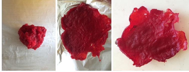
Şekil 56. Agar agar ve kırmızı gıda boyası kullanılarak yapılan patates nişastalı biyoplastik, Alüminyum folyo üzeri katı sürüm (Deney 17-33)
