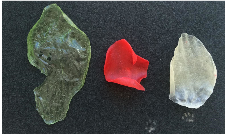
Şekil 64. Tapiyoka nişastalı ve agar agarlı biyoplastik (Deney 17-37)
