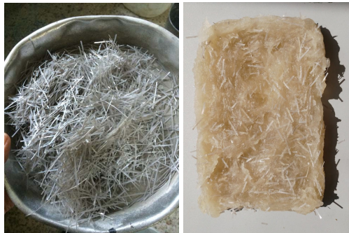
Şekil 88. Kopolimer lifli patates nişastalı biyoplastik, Boyut: 15x22x0,8 cm (Deney 17-7)
