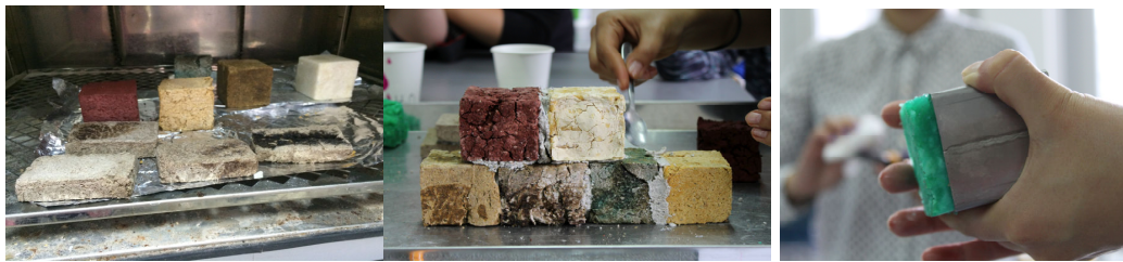
Şekil 93. Biyoplastikten yapılan küçük bir duvar örneği, modül boyutları: 6x6x6 cm, Bağlayıcı: Alçıtaşı, kireç ve 0/1, 0/4 agrega, Future Architecture Festival, Ljubljana çalıştayı
