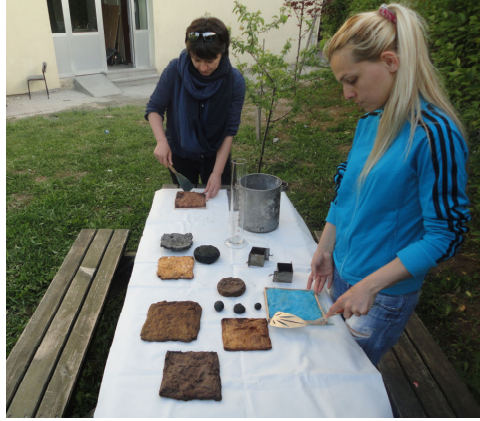
Şekil 86. 15x15x0,3cm'lik numunelerin kurutulmadan önce kalıplanması
