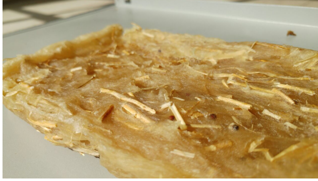
Şekil 74. Bitkisel lifli biyoplastik, Boyut: 15x22x0,8 cm (Deney 17-7)
