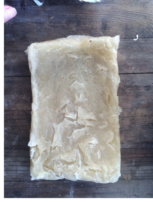
Şekil 53. Patates nişastalı saf biyoplastik, Ahşap kalıp, Boyut: 15x22x0,8 cm (Deney 17-5)
