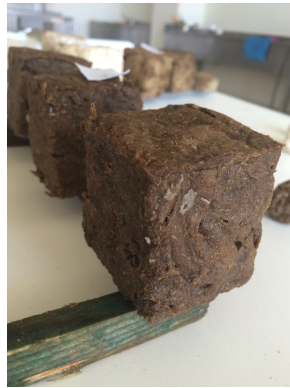
Şekil 82. Balmumlu kanola peletli biyoplastik, Boyut: 6x6x6cm (Deney 17-14)
