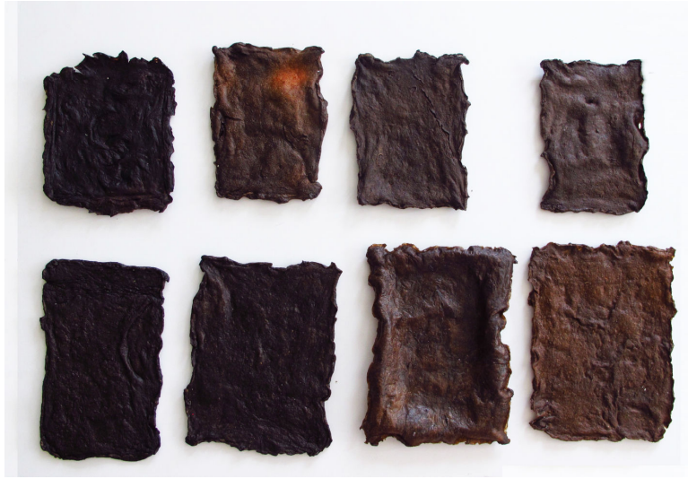
Şekil 87. Farklı oranlarda kahve telvesi ve lif kullanılarak üretilen biyoplastiklerin 250 °C kuruma sonrası, 15 x 20 x 0, 3 cm, sırasıyla kahve telvesi, biber, kahve telvesi-zerdeçal, kanola peleti-biber-metilen, kahve telvesi, kanola ve kömür tozlu pelet, kahve telvesi-fazla nişasta, kahve telvesi-meşe külü, kanola peleti-zerdeçal
