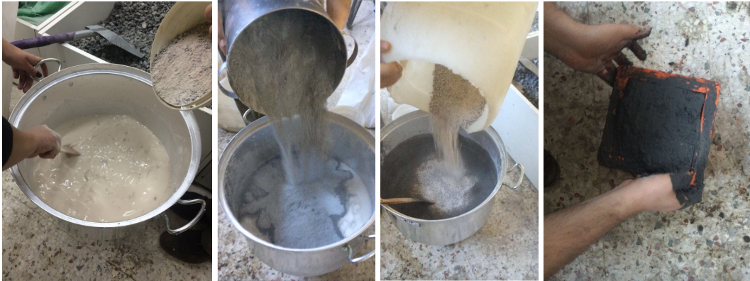
Şekil 48. % 50 Biyoplastik, % 50 Karışım: (Agrega 60%, 40% silis dumanı), Çelik kalıp, Boyut: 15 x 15 x 15 cm (Deney 16-6)
