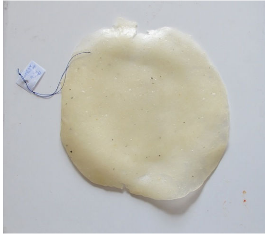
Şekil 61. Kavun çekirdeği unu, şeker/limon suyu karışımı ile yumurta akı kullanılan yüzeyler (Deney 17-75, 17-77, 17-77).
