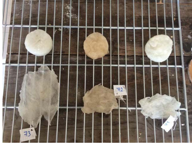
Şekil 58. Üç farklı sirke türü kullanılarak yapılan patates nişastalı agar agarlı biyoplastik (sırasıyla beyaz, üzüm ve elma sirkesi soldan sağa doğru) (Deney 16-73, 16-72, 16-71)
