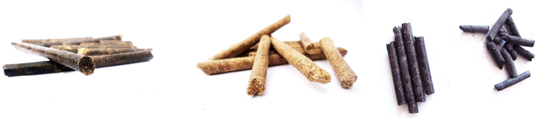
Şekil 79. Peletler (Kanola sapı, melaslı, kanola sapı ve kömür tozlu, melas ve küllü pelet)
