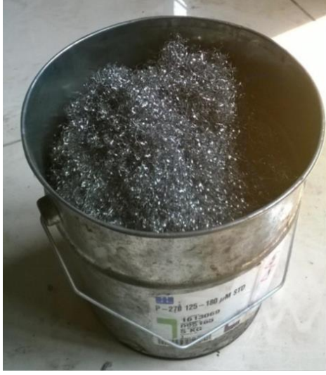
Şekil 4. 5. Filtrelerde kullanılan paslanmaz çelik talaşı (Aktaş T, Dalmış İS, Tuğ S, 2016)
