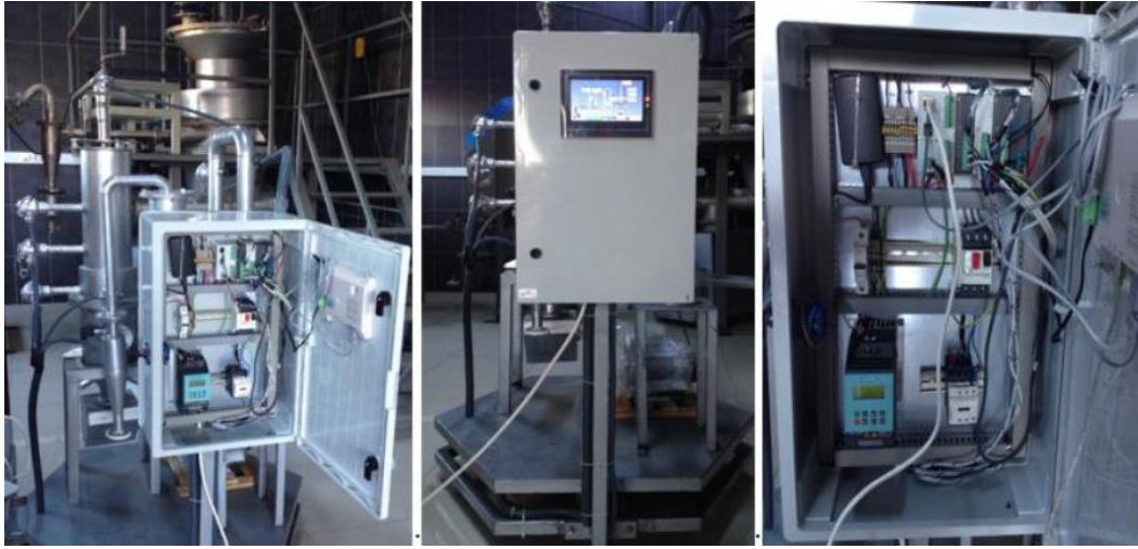
Şekil 4. 11. NKUBAP.00.MB.AR.14.03 no'lu proje ile geliştirilen ölçüm ve kontrol sistemi (Aktaş T, Dalmış İS, Tuğ S, 2016)
