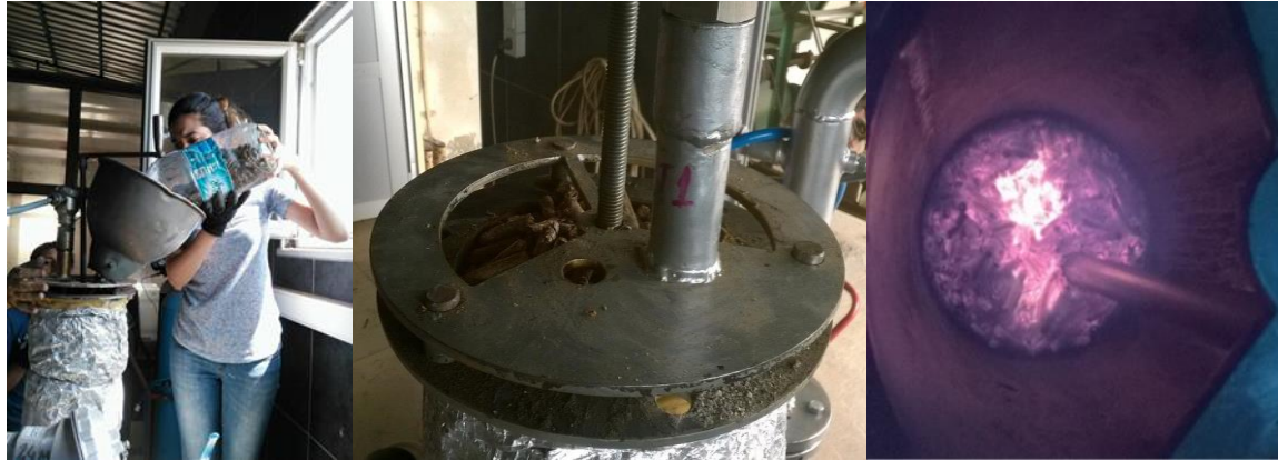
Şekil 4. 13. Gazlaştırma deneyinin başlanması (full yükleme) ve bitişi (korun üst kısımdan görünmesi)
