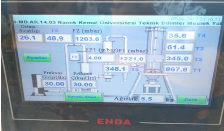
Şekil 4. 12. Ölçüm ve kontrol donanımı görüntüleme ekranı
