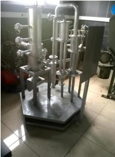
Şekil 4. 2. İmalatı tamamlanmış gazlaştırma reaktörü (Aktaş T, Dalmış İS, Tuğ S, 2016)
