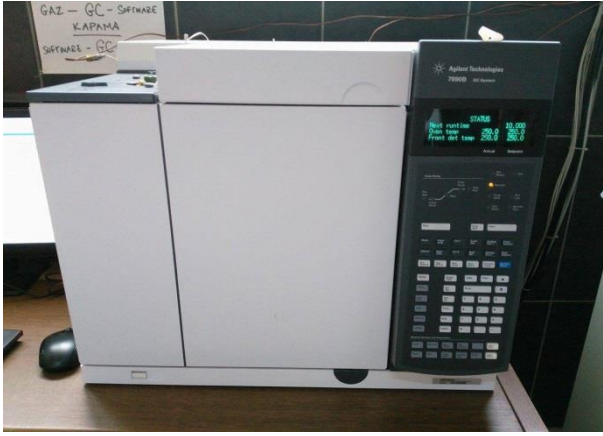
Şekil 4. 9. Gaz analizlerinde kullanılan gaz kromatografi cihazı (Aktaş T, Dalmış İS, Tuğ S, 2016)
