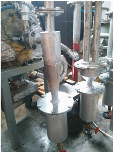
Şekil 4. 4. Gaz temizleme sistemi (Aktaş T, Dalmış İS, Tuğ S, 2016)
