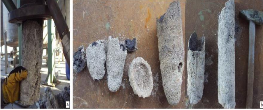
Şekil 1. 6. Yatak bağlamasına ait fotoğraflar (a) Reaktördeki ergimiş yatak (b) Reaktörden çıkan ergimiş kül ve yatak malzemesi.
