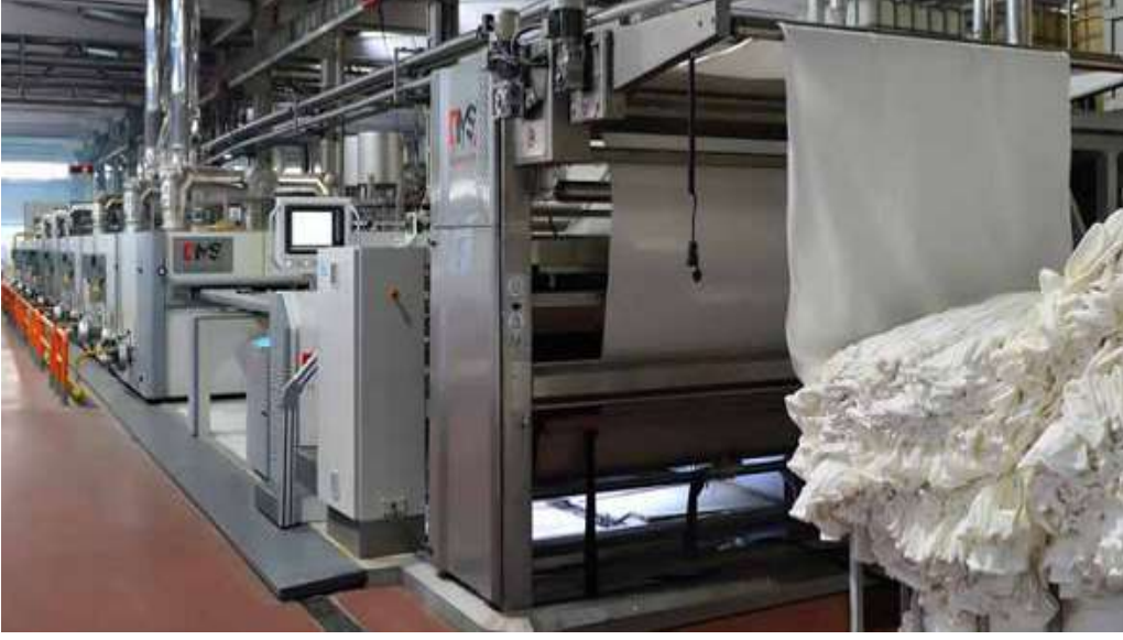
Şekil 4.2. Kumaş kurutma ve en fikse makinesi (Dilmenler)
