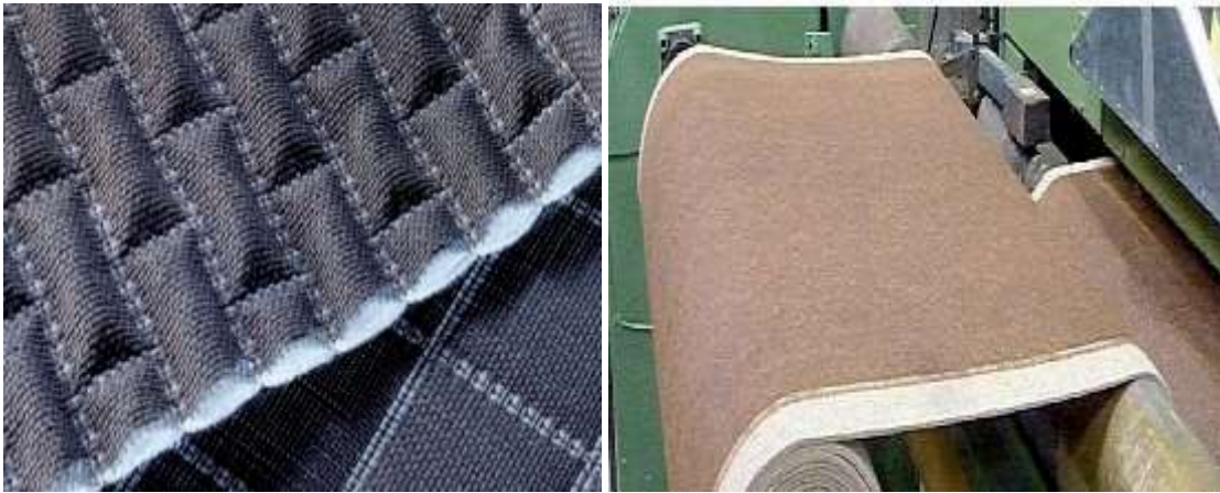
Şekil 2.1. Ses yalıtım ve mat (fibripreg flax) teknik kumaşları örneği
