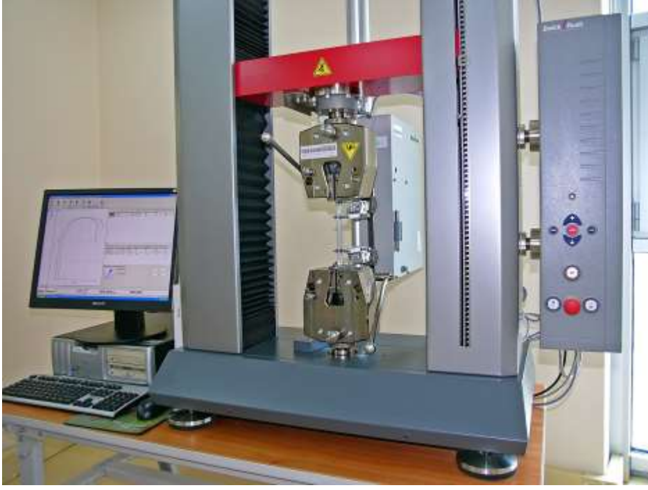
Şekil 4.5. Yırtılma dayanımı ve uzama ölçüm cihazı
