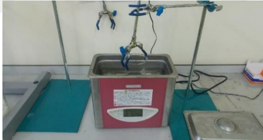
Şekil 3.1. Ultrasonik boyamalarda kullanılan cihaz ve düzenek
