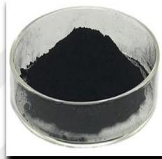
Şekil 2.5. Bizmut (III) selenür ve bizmut(III) tellerür bileşiklerinin fiziksel görünümü
