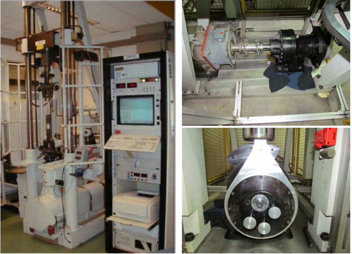
Şekil 4.1. Amortisör Performans Test Tezgahı
