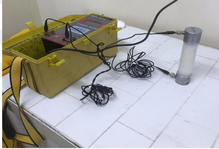
Şekil 4.5. Ultrasonik test cihazı
