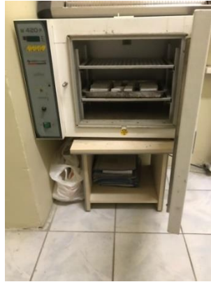
Şekil 4.8. Kuru yüzey doymuş ağırlığı deney aşamaları
