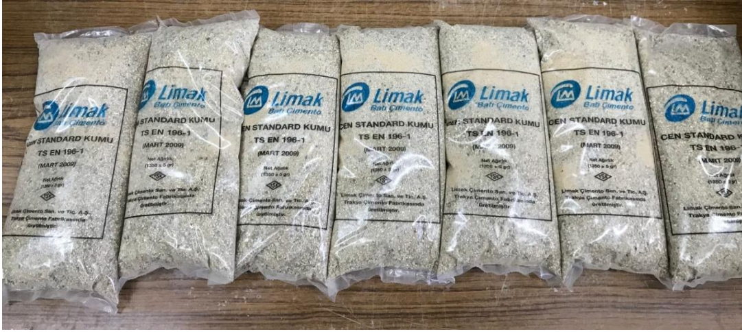
Şekil 4.4. Deneyde kullanılan rilem kumu
